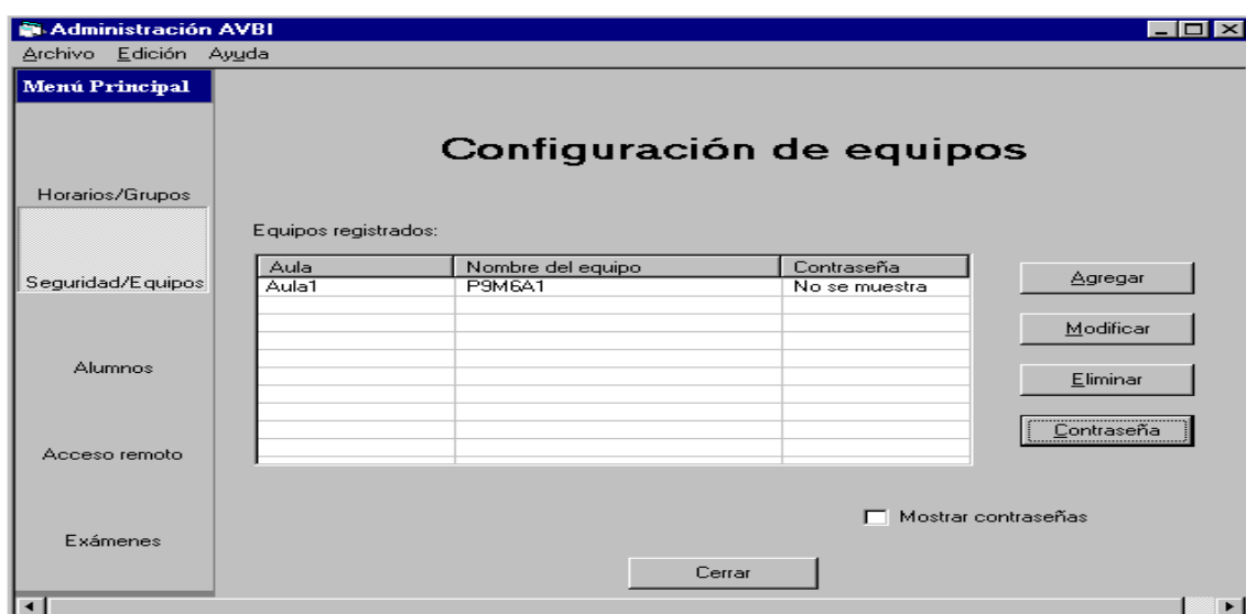
Figura 1.75 Sección de la ventana de la Administración del Aula Virtual con Butaca Interactiva que se utiliza reconocer la conexión de red entre la administración y las aulas virtuales y asignar y modificar contraseñas que sólo el maestro conozca para abrir los programas en el salón de clases.
