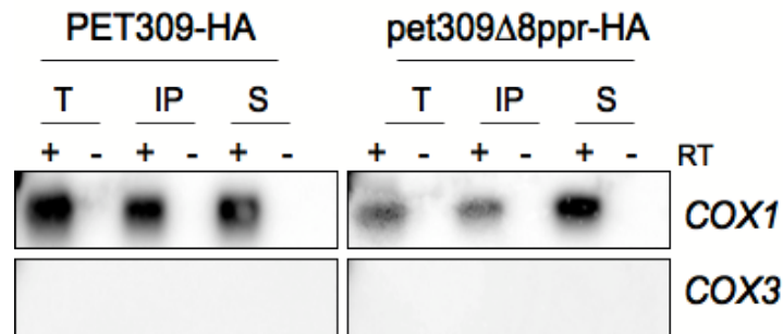
Figura 11. Confirmación de que el producto de PCR obtenido durante la IP de Pet309 es COX1 . Southern blot donde se demuestra que los productos amplificados de la inmunoprecipitación es COX1 detectándose en la fracción total (T), inmunoprecipitada (IP) y el sobrenadante (S). RT= reverse transcriptase. El panel superior es el amplificado de COX1 y el panel inferior es de COX3 . Ambos experimentos se hibridaron con la sonda de COX1 .
