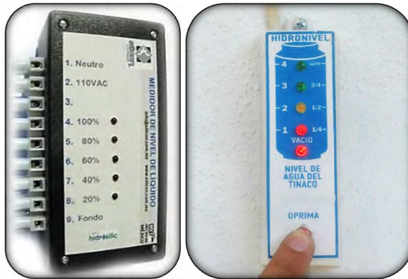
Ilustración 2: Monitores de nivel electrónicos más comunes.
