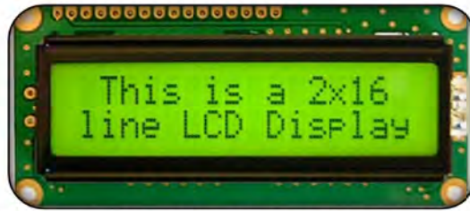
Ilustración 32: Pantalla LCD 16x2 con luz de fondo.
