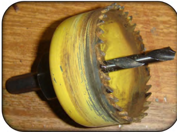
Ilustración 45: Herramienta para perforar la tapa del tinaco.
