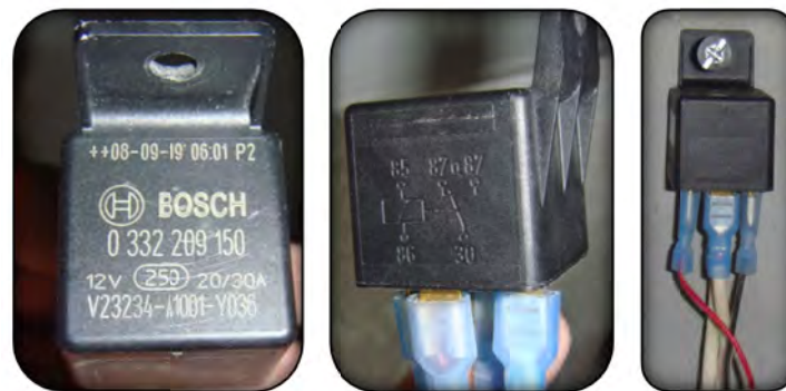
Ilustración 29: Relevador Bosch modelo: 0 332 209 150, soporta una corriente de 30 A, y la señal de activación es de 12V.
