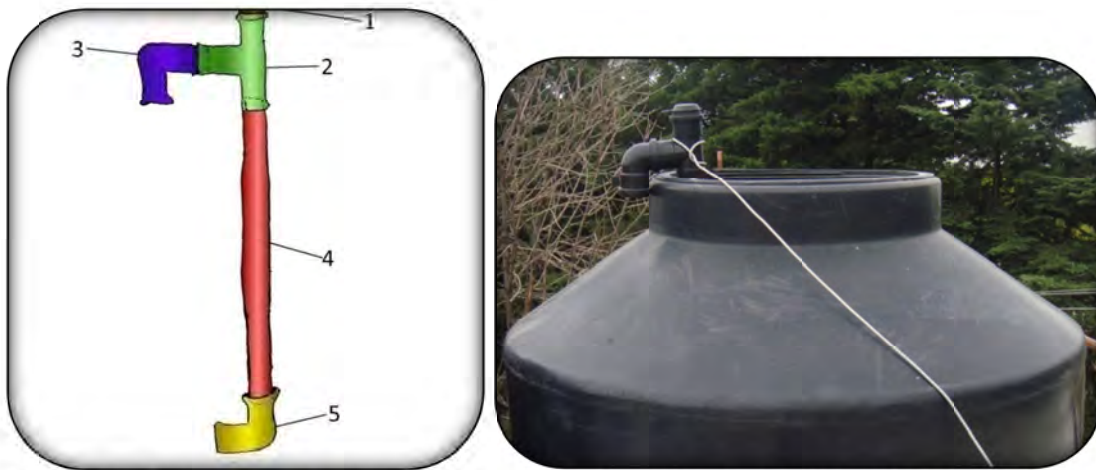
Ilustración 15: Cinco piezas de tubería que forman la estructura del sensor óptico. 1-Tapa, 2-T, 3 y 5-Codo de 90°, 4-Tramo de tubo.
