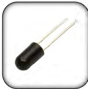
Ilustración 9: Fototransistor con filtro infrarrojo.
