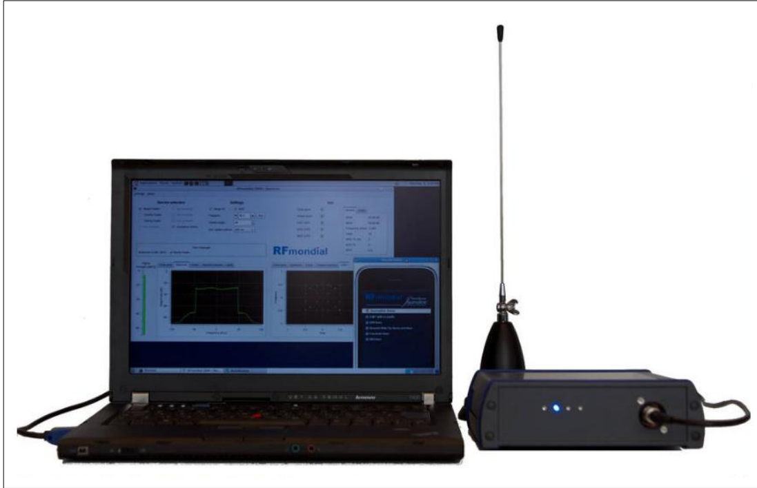
Figura 3.29. RFmondial Frontend (derecha) y software del receptor DRM+ (izquierda).
