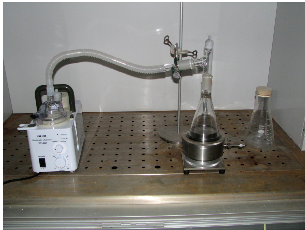
Sistema del proceso de rocío pirolítico ultrasónico
