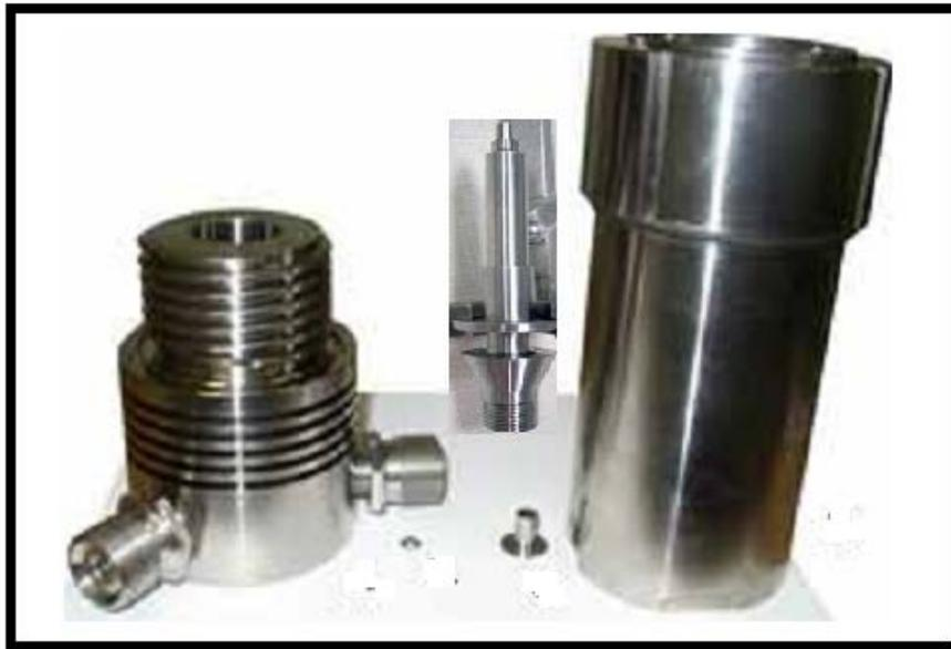
**Figura 2.7 Partes de la celda de presión.**
