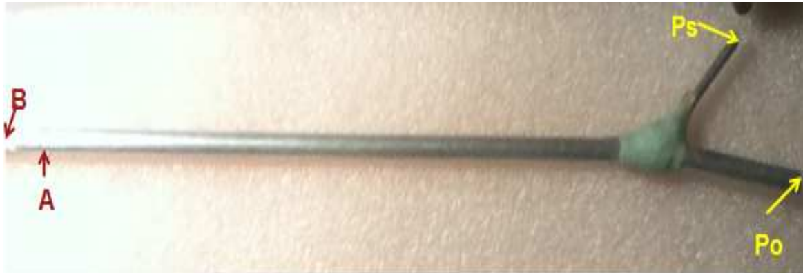
Figura 7. Tubo de Pitot-1: presión estática, entrada (A) y salida ( P_o ). Presión dinámica, entrada (B) y salida ( P_s ).
