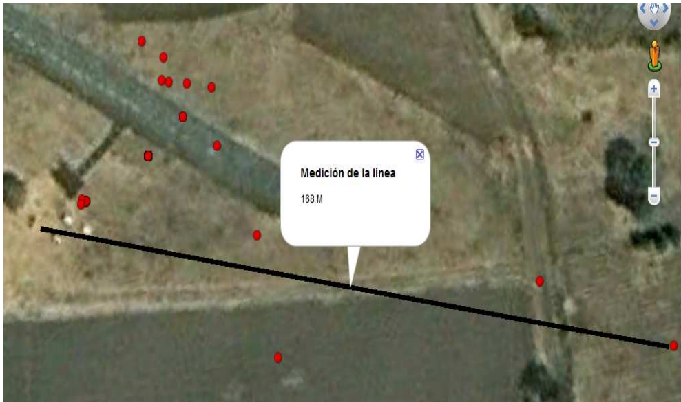
Figura 62. Rango máximo de alcance registrado mediante el modulo de comunicaciones HM-TR915.
