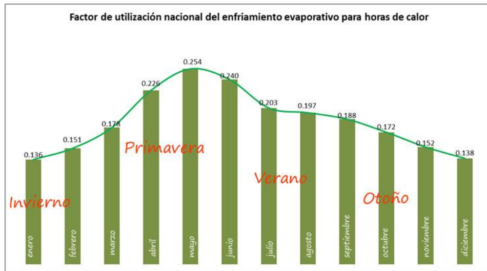
Gráfica 7.3 Factor de utilización del enfriamiento evaporativo en las principales ciudades del país considerando únicamente las horas de calor de los requerimientos bioclimáticos presentes.
