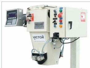
Figura 4.4 Envasadora electrónica para granulados (COMAIZ, 2010)
