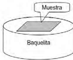
Figura 2.8: Diagrama del montaje de la muestra.
