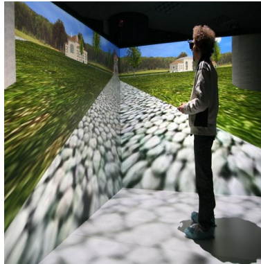
Figura 3.3: Ejemplo de un sistema CAVE
