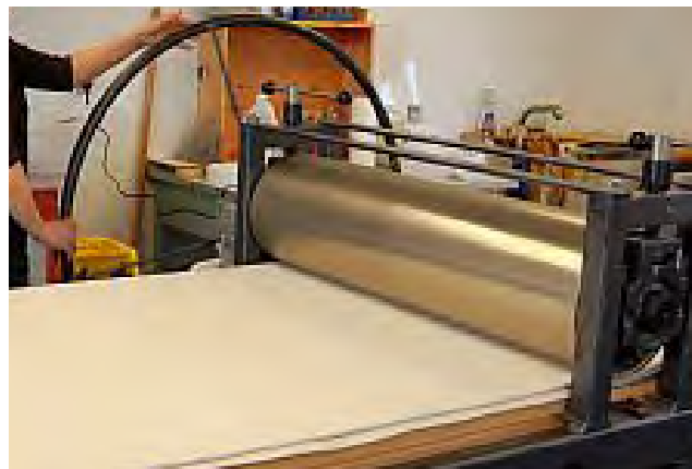
La presión se ajusta de acuerdo al grosor del plato y de la intensidad con que se quiere que se marque el grabado
