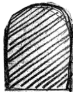
Vano con de arco de medio punto
