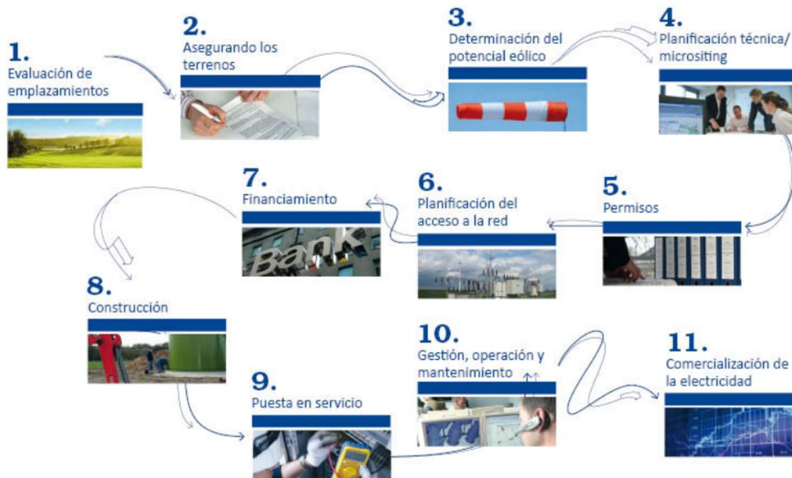
Figura 4.1. Ciclo de ejecución de un proyecto eólico
