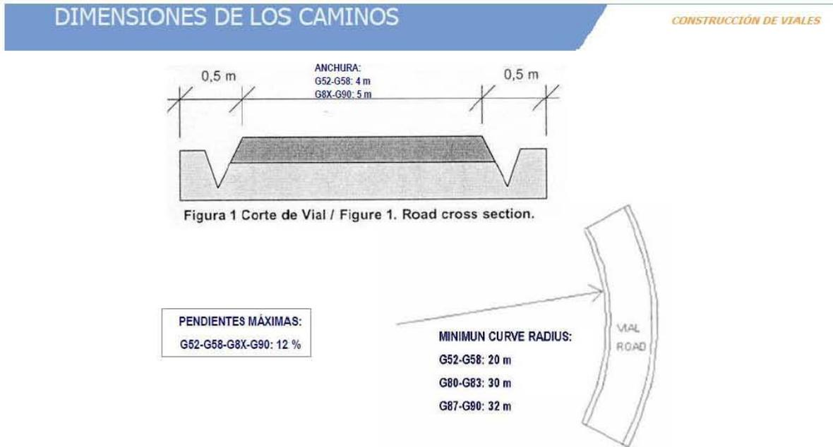
Figura 3.22 Dimensiones de caminos y radios de curvatura de fabricante de aerogeneradores.
