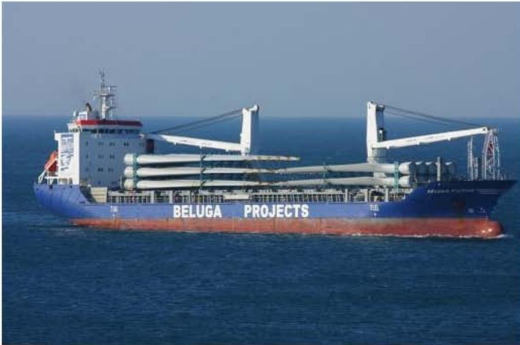
Figura 3.17 Transporte marítimo de aspas de aerogeneradores
