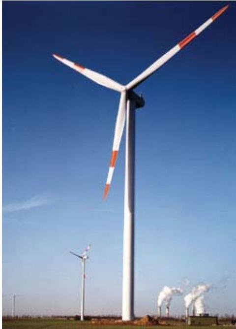
Figura 1.24. Aerogenerador de eje horizontal, tripala, barlovento.
