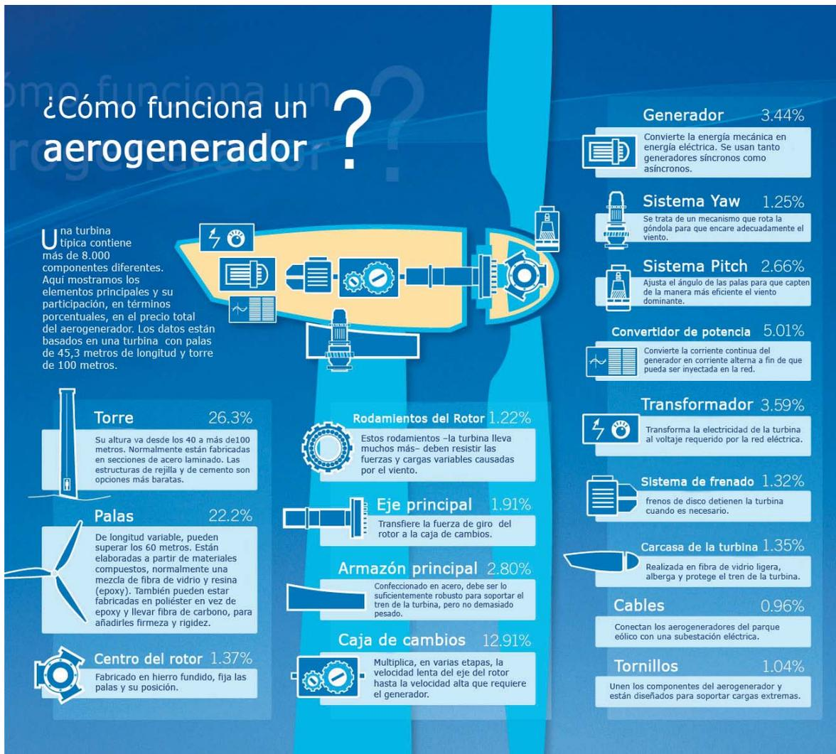
Figura 1.27 Elementos principales de un aerogenerador y su participación en el precio total del aerogenerador.
