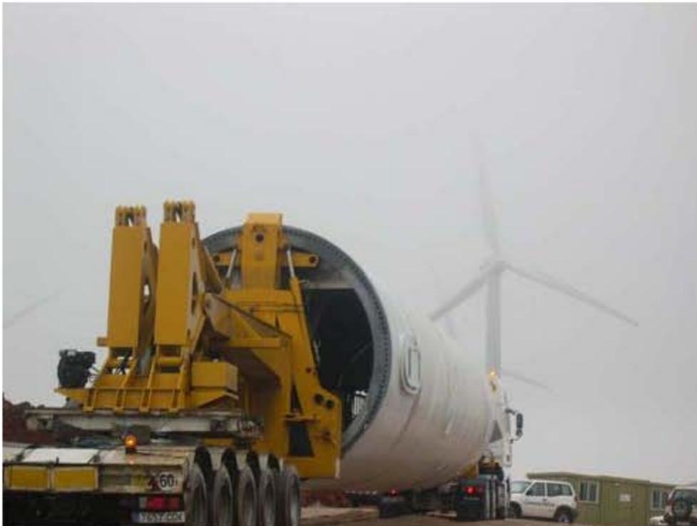
Figura 3.18 Transporte de tramos de torre de aerogeneradores.
