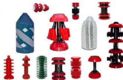
Ilustración 6.3 Diablos de poliéster, puede ser de espuma desnuda o cubierto con un material de poliuretano, puede tener un recubrimiento en espiral de poliuretano, cepillos de diversos materiales o de carburo de silicio para mejorar la capa de lavado de la pared (<http://www.indiamart.com/vp-engineers/pipeline-accessories.html>).
