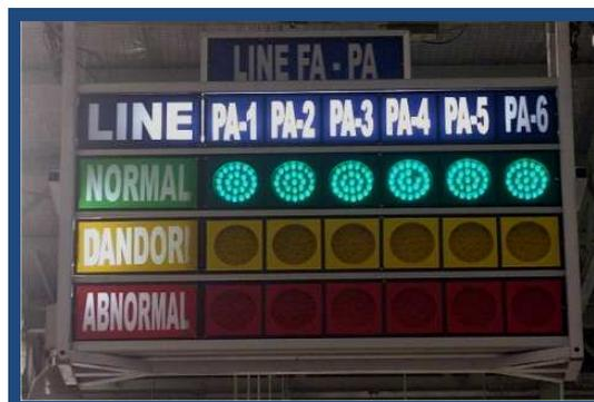
Figura 47 Sistema Andon en una línea de Producción
