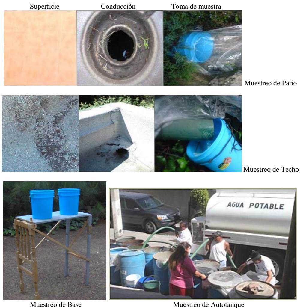
Figura 4.2. Puntos de muestreo en una casa del Ecobarrio para la evaluación de la calidad de agua de lluvia.
