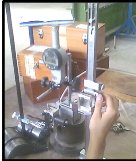
Figura 4.3.- Calibración de un sensor LVDT, PS5M57 montado en un arreglo para pruebas de tensión en probetas circulares normalizadas, con apoyo de un vernier y un micrómetro.
