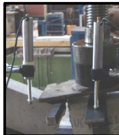
b) Núcleo acondicionado con resorte
