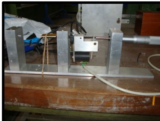
Figura 4.2.- Calibración de un LVDT PC1M-23 montado en un marco de mediciones longitudinales basado en un tornillo micrométrico
