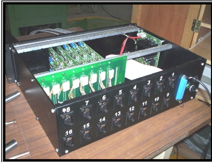
Figura 3.3 se muestra al gabinete que contiene las tarjetas que acondicionan las señales enviadas por los sensores de fuerza y desplazamiento, mismos que son instalados en las conexiones al frente del gabinete, identificados con números.
