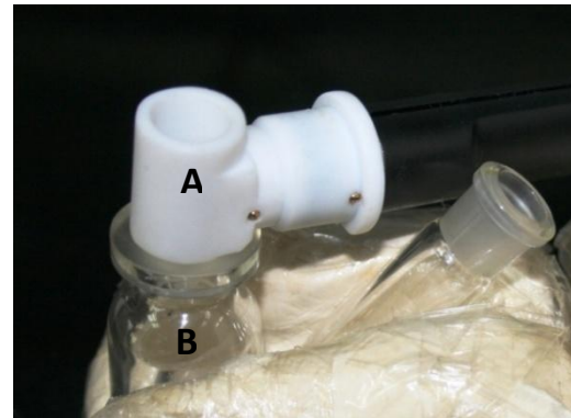
Figura 19. Brazo sensor del Tewameter® (A) colocado sobre el receptor de una celda de Franz (B).
