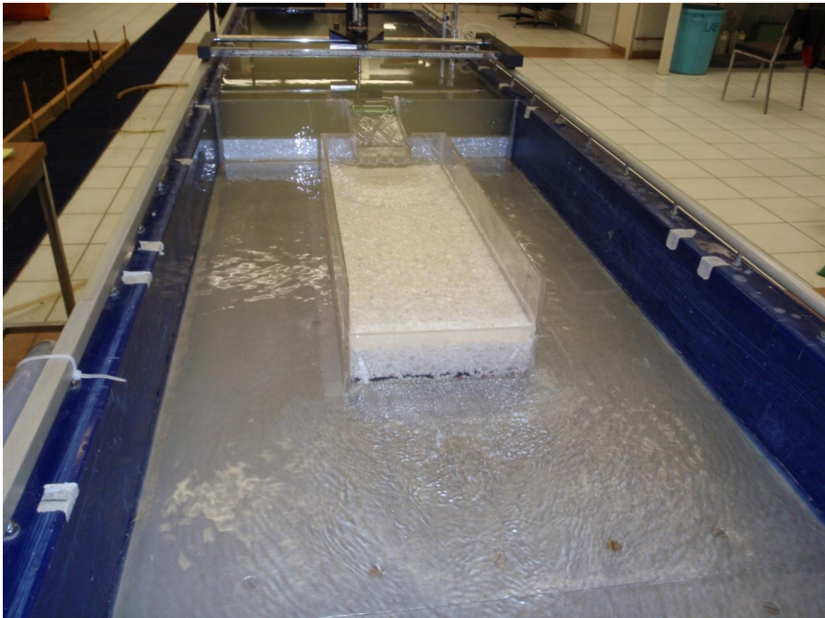
Figura 4.2 Fotografía frontal de la instalación experimental, obsérvese el material no cohesivo (blanco) en su cajón
