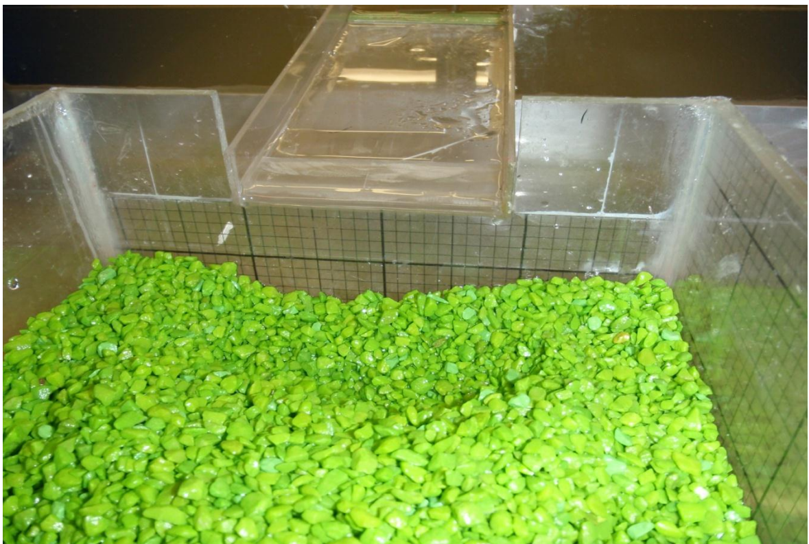
Figura 4.6 Socavación provocada por el gasto mínimo
