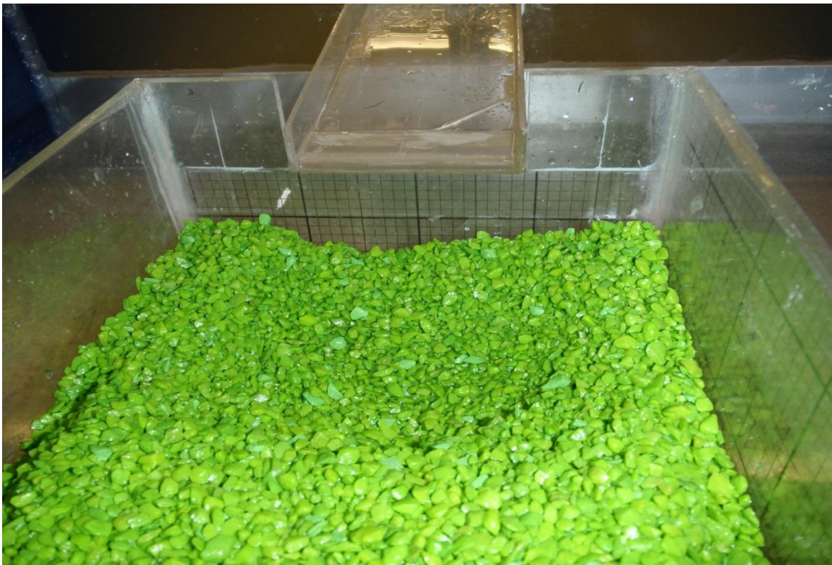
Figura 4.4 Socavación provocada por el gasto máximo
