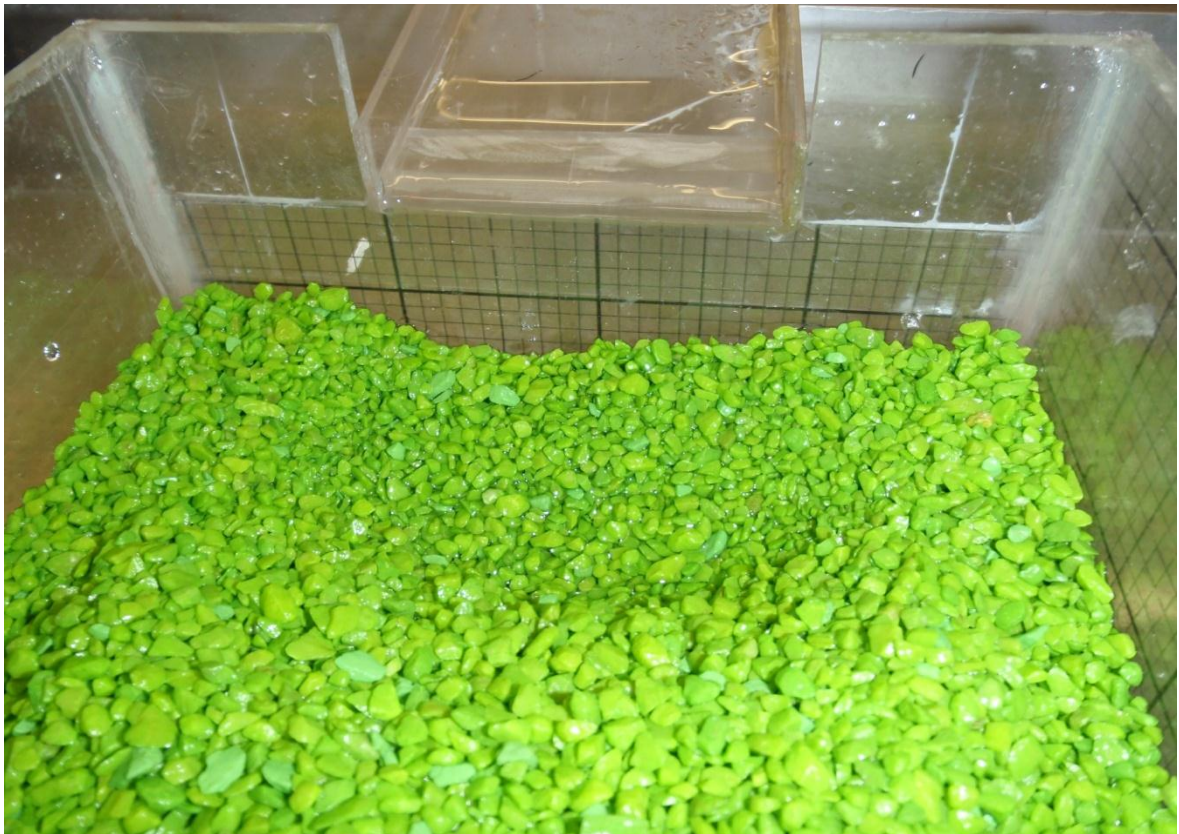
Figura 4.5 Socavación provocada por el gasto medio
