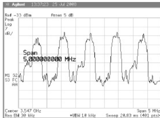
Figura 4.6. Interferencia por microonda WiMAX.
