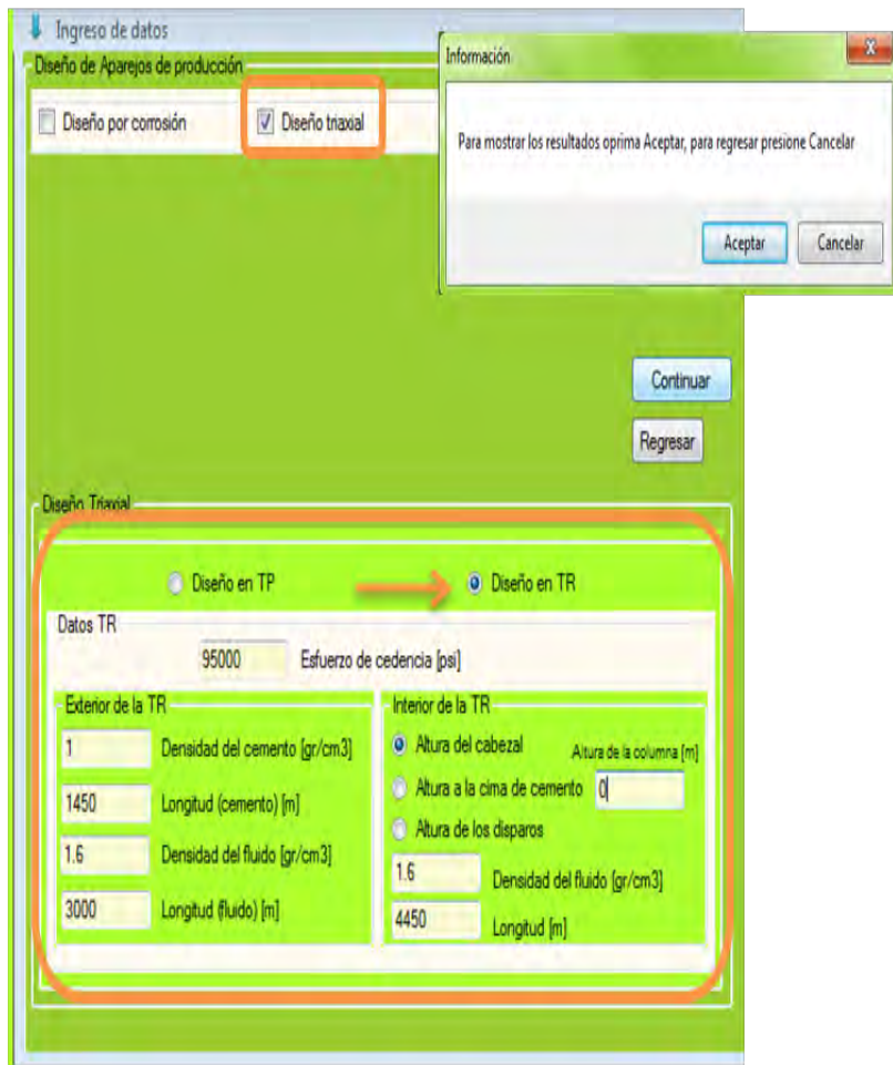
IMAGEN IV. 19 Pantalla de inserción de datos particulares para la operación de “aparatos de producción”. En el recuadro inferior se aprecia que se ha seleccionado “diseño de TR y los datos ingresados.
