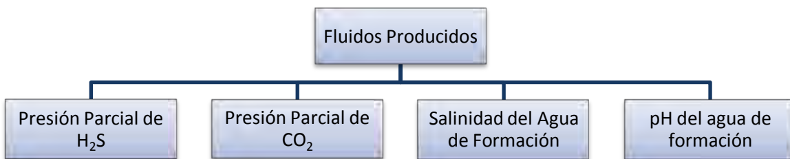
IMAGEN I.10.3.- Parámetros para la selección de empacadores: Fluidos producidos
