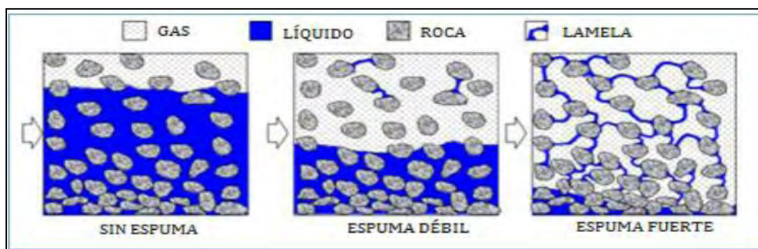
Fig. 2.6 Comparación de un flujo convencional de agua-gas con una espuma débil y una fuerte (Dholkawala et al. 2007)
