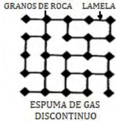
Fig. 3.6 Espumas de gas discontinuo (Rossen, 1994)
