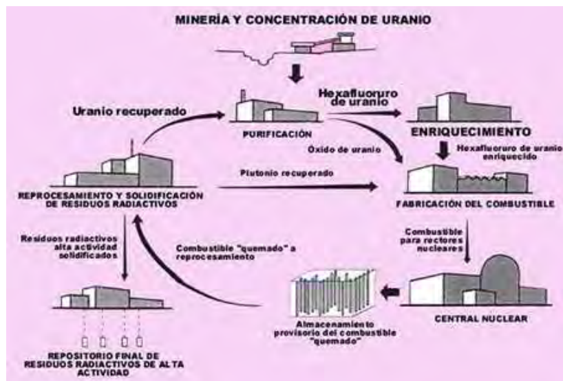
Figura 3.2. Ciclo del combustible nuclear con reprocessamiento y reciclado de combustible gastado.
