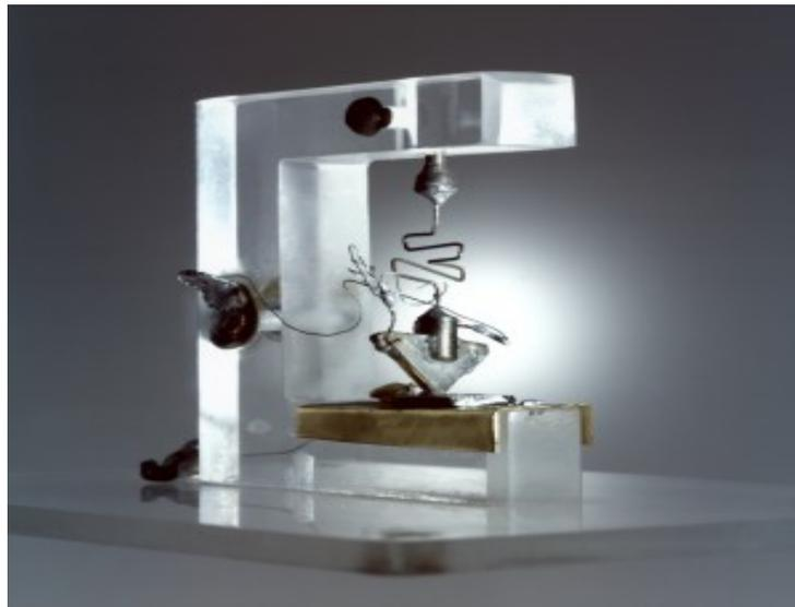
Figura 1.1. Primer transistor desarrollado en los Laboratorios Bell.
