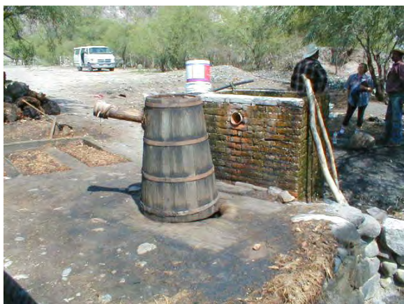
Fig. 32. La montera o comúnmente llamado “el viejo” es el artefacto de madera que cubre al recipiente de cobre donde es depositado el maguey cocido y macerado con agua. La unión de ambos se designa como alambique en la comunidad de San Miguel Temoaya en el estado de Durango.
