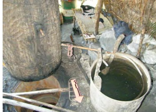
Fig. 65 y 67. Cerca de la población de Malinalco en el estado de México, comunidad de Zumpahuacán, encontramos destiladores con monteras de madera para los alambiques y hornos de pequeñas dimensiones con paredes de tierra.
