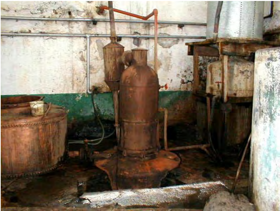
Fig. 117. El alambique de cobre con doble rectificador lo hemos encontrado en las fábricas del norte del país como Laguna Seca de San Luis Potosí y Saldaña en Zacatecas.
