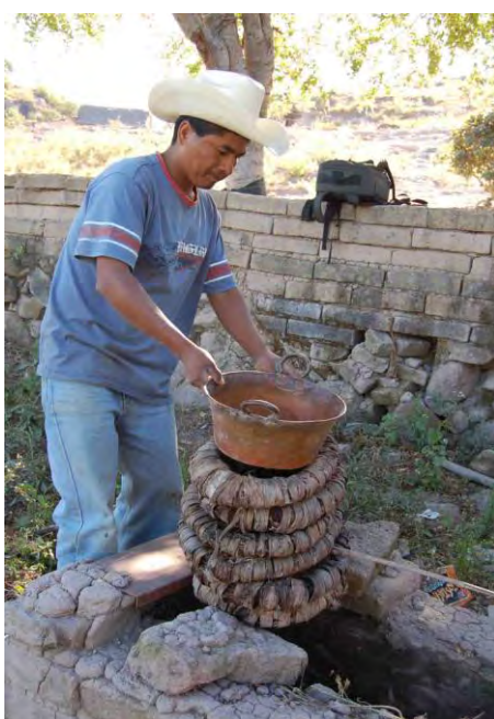
Fig. 119. En la comunidad de Guadalupe Ocotán, Nayarit, se usa un cazo de cobre como condensador, En este recipiente metálico se vierten agua de manera continua para con ello se permita la condensación.
