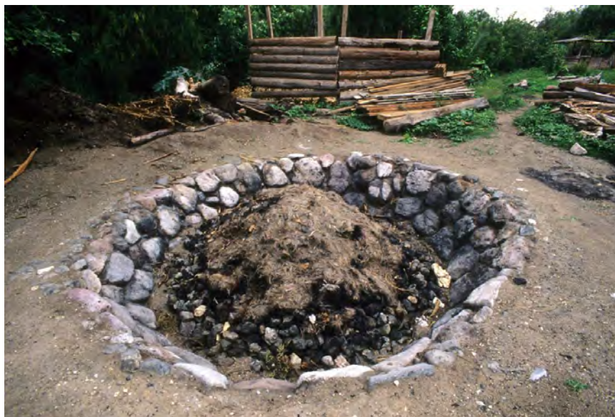
Fig. 23. En algunas comunidades de Oaxaca como Chichicapan todavía se usan hornos hechos en el suelo con paredes revestidas de piedra.
