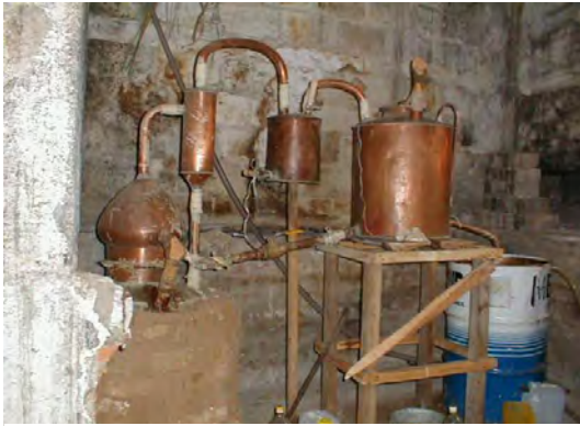
Fig. 43. El estado de Hidalgo es reconocido por la producción de pulque. Sin embargo, en Acaxochitlán encontramos la producción de aguardiente de caña con alambique refinado.
