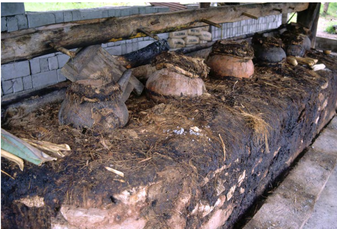
Fig. 27. Ollas de pequeño tamaño caracterizan las instalaciones que producen mezcal en San Juan Sola de Vega.
