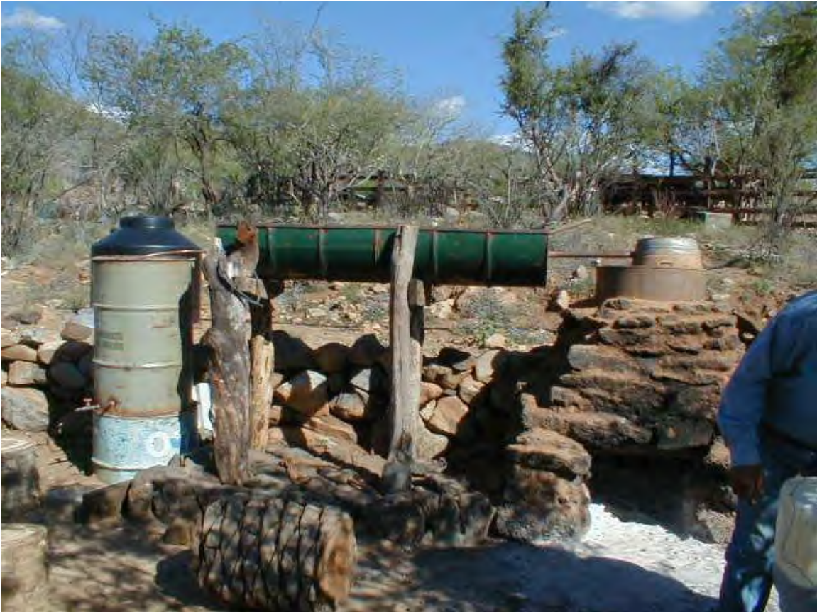
Fig. 123. En el alambique localizado en Moctezuma, Sonora, el serpentín se encuentra colocado en un tambo de metal.
