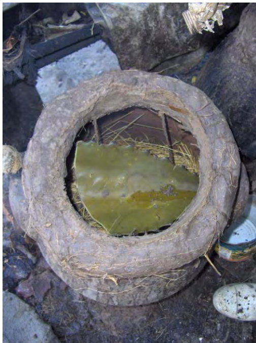
Fig. 107. Una penca recién cortada a manera de batea, es el elemento que se utiliza en el interior del alambique de ollas que tiene la fábrica de Jiquilpan, Michoacán.
