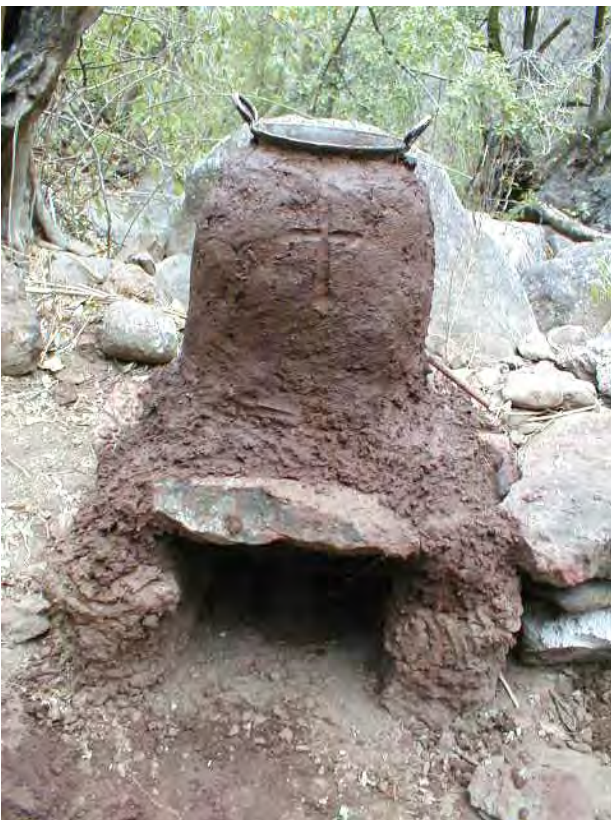
Fig. 37. La instalación de producción de mezcal que mayormente nos sorprendieron fue la que registramos en la comunidad huichola de Guadalupe Ocotán. En este lugar encontramos un alambique elaborado con rodillos de corteza de árbol superpuestos cubiertos con lodo. Es sin lugar a dudas, el destilador rústico más significativo que hemos registrado.
