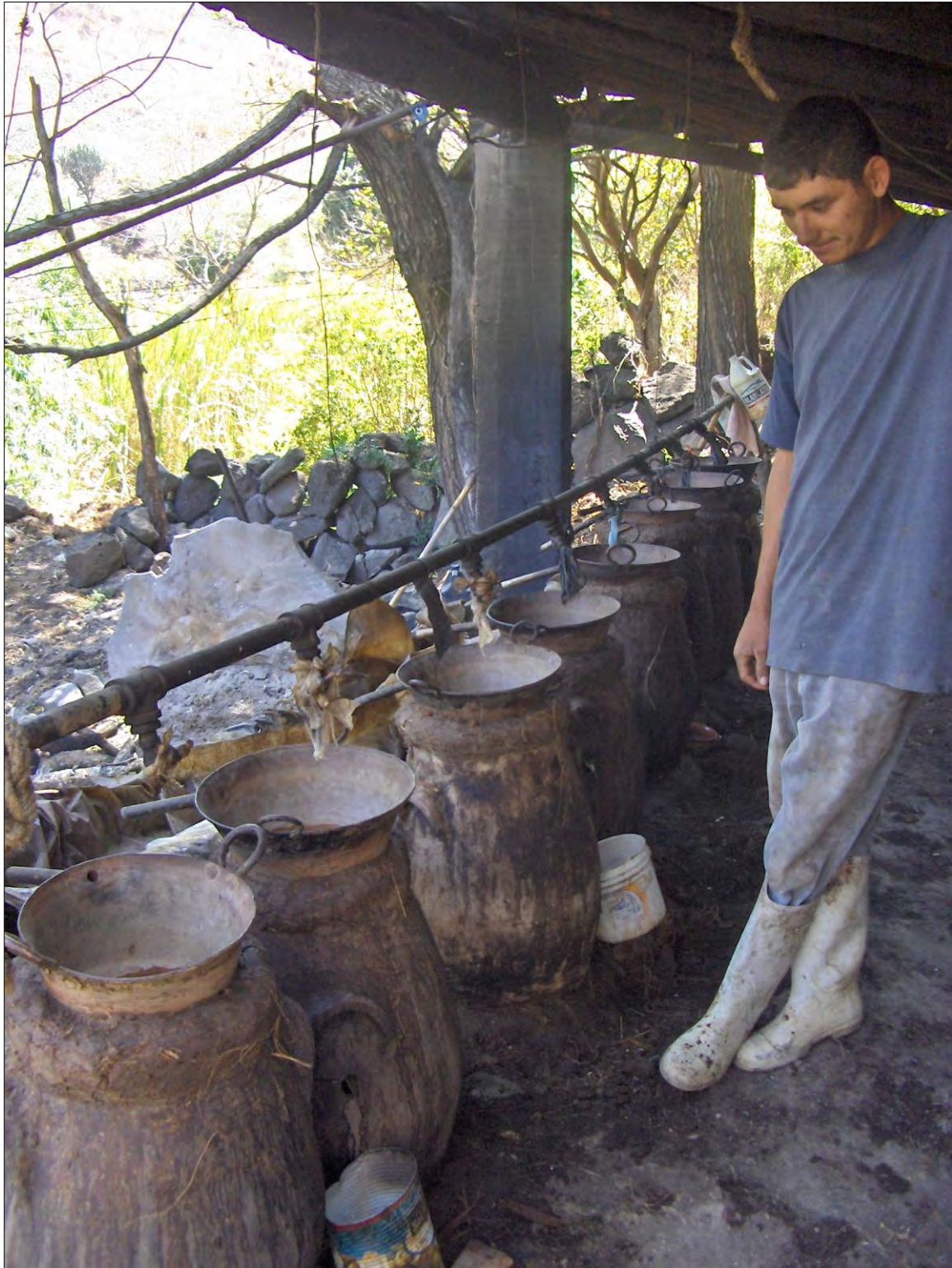
Fig. 109. Fábrica de mezcal con alambiques de ollas superpuestas en Jiquilpan, Michoacán.
