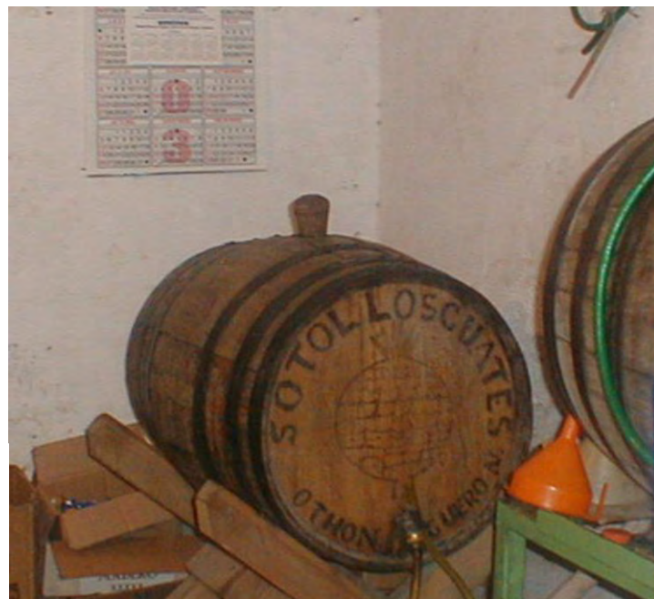
Fig. 50. Algunas fabricas almacenan su producto en barricas de roble con el fin de que adquiera sus esencias y con ello comercializarlo como añejo o reposado.
