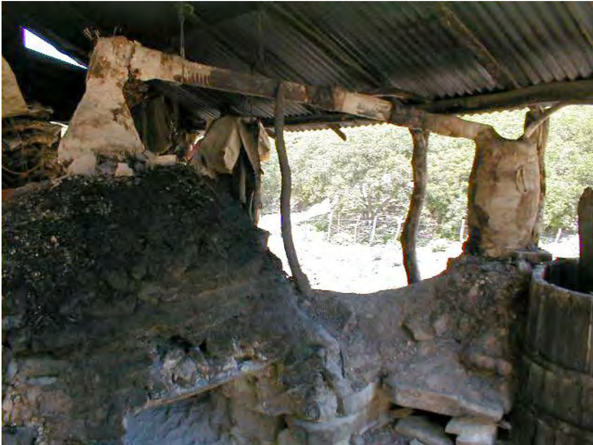
Fig. 115. Con más de 15 años de uso, el alambique con rectificador registrado en la comunidad de Aguazarca del estado de Tamaulipas, todavía produce un mezcal de excelente calidad.
