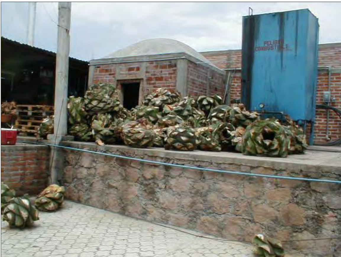
Fig. 88. Detrás de las piñas de maguey se observa el horno de cámara de ladrillo y junto a él, la caldera que suministra el vapor. Teúl de González Ortega, Zacatecas.
