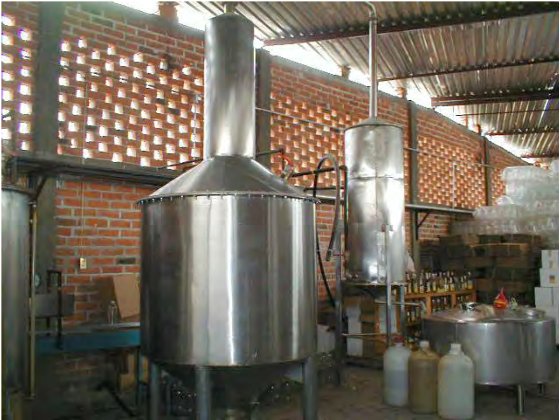
Fig. 113. Con una duración de hasta 30 años, el alambique cilíndrico de acero es el que se usa en las instalaciones localizadas en Teul de González Ortega del estado de Zacatecas
