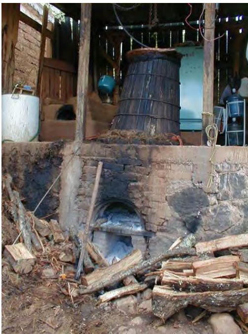
Fig. 41. La unión de la montera con el cazo de cobre que contiene el maguey fermentado, es sellado con el bagazo resultado de la destilación. Tal y como lo observamos en esta foto del alambique encontrado en la comunidad de Oponguio, estado de Michoacán.
