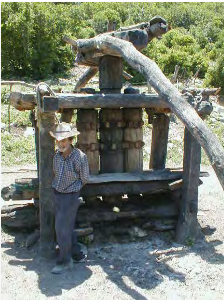
Fig. 97. En Aguazarca municipio de San Carlos, Tamaulipas, se utiliza la prensa vertical muy parecida a las que se utilizan para triturar la caña de azúcar
