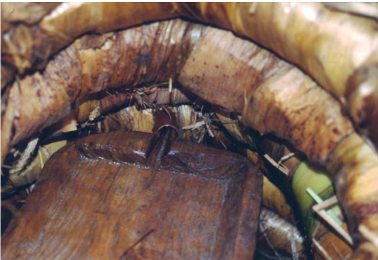
Fig. 106. Es interesante como en el caso del destilador de los huicholes de Guadalupe Ocotán, Nayarit, se coloca una pequeña batea de madera en su interior, de tal manera que cubra el diámetro del alambique y tenga una conexión con el tubo de cobre que permite la salida del mezcal.
