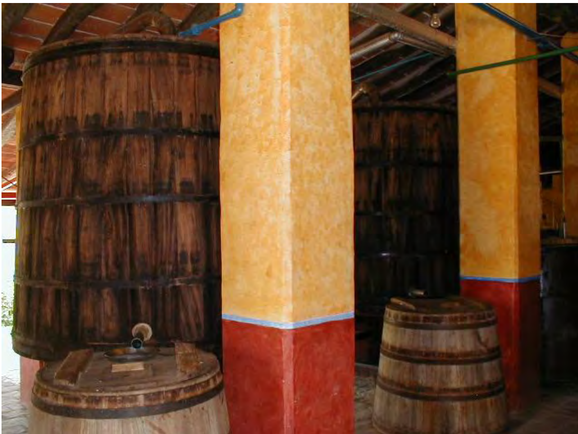
Fig. 111. Tonel de madera en el que se encuentra el serpentín de enfriamiento de un alambique de olla. Instalaciones La Noria, Sinaloa.
