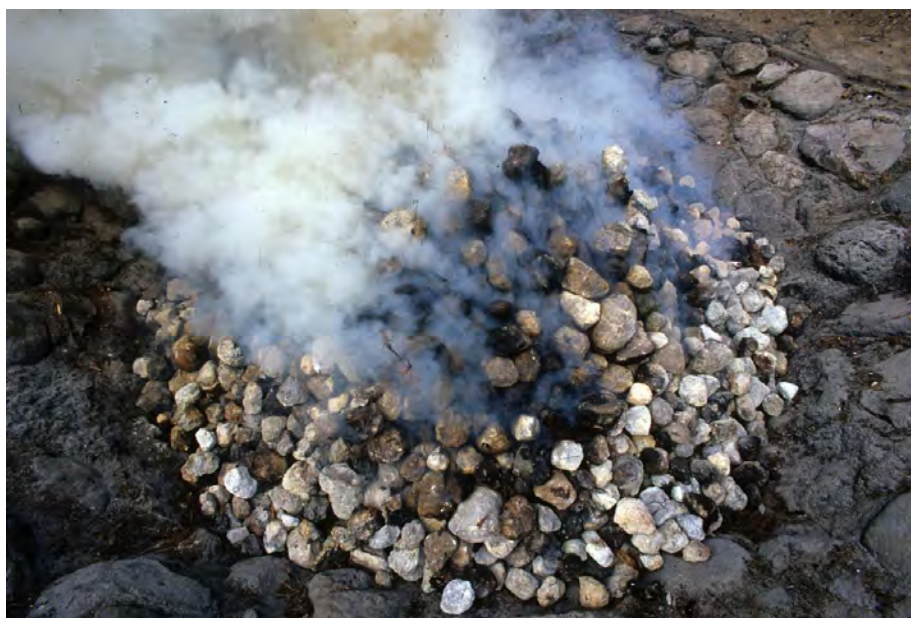
Fig. 83. Horno encendido con piedras listas para recibir las piñas de maguey cortadas. Horno de paredes de piedra en la comunidad de Santiago Matatlán. Oaxaca.
