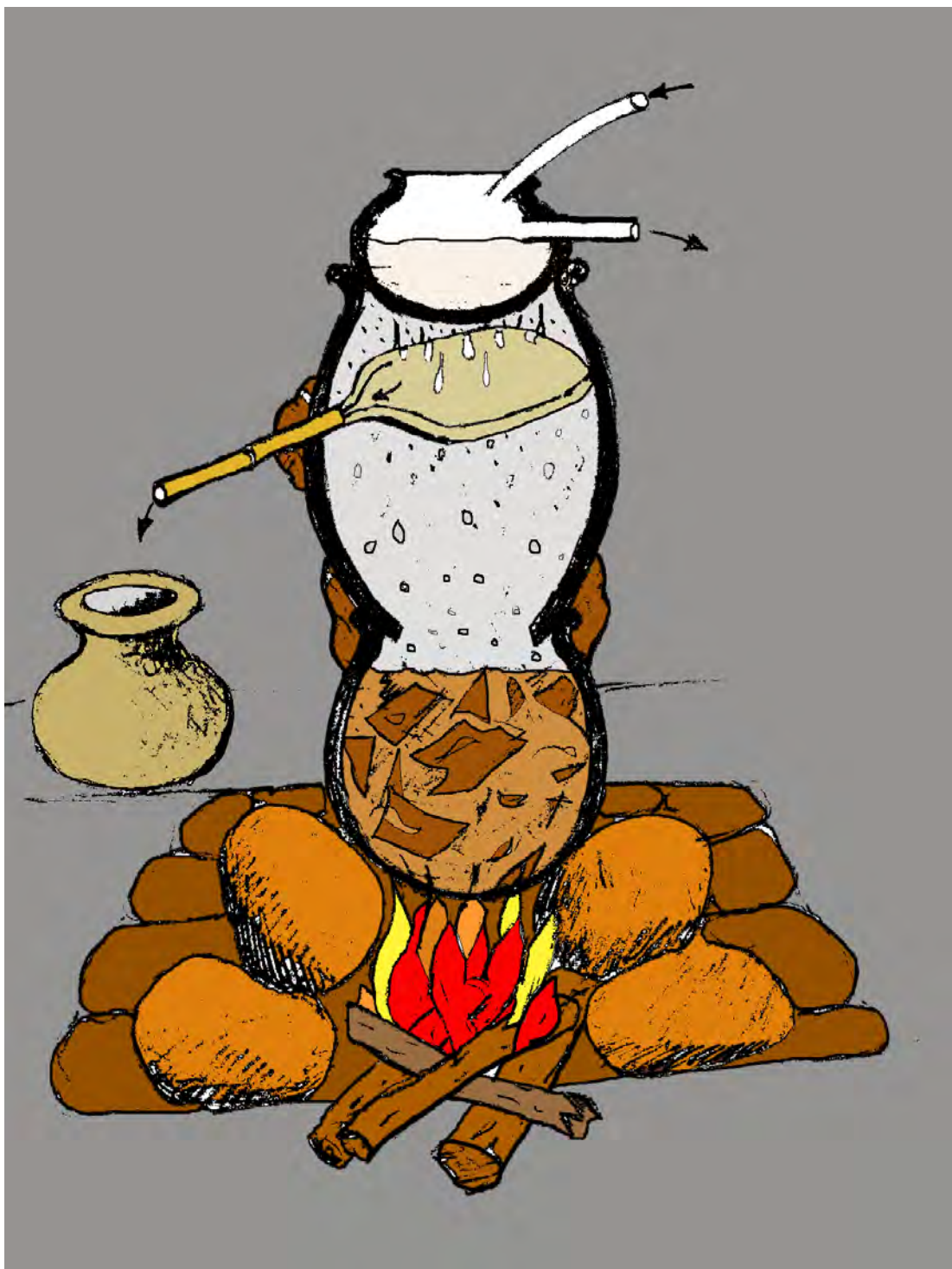
Fig. 136. Recreación del alambique y sistema de destilación que consideramos se utilizó en las unidades habitacionales del sitio Cacaxtla-Xochitecatl durante el periodo Formativo. Dibujo Carlos Lazcano.
