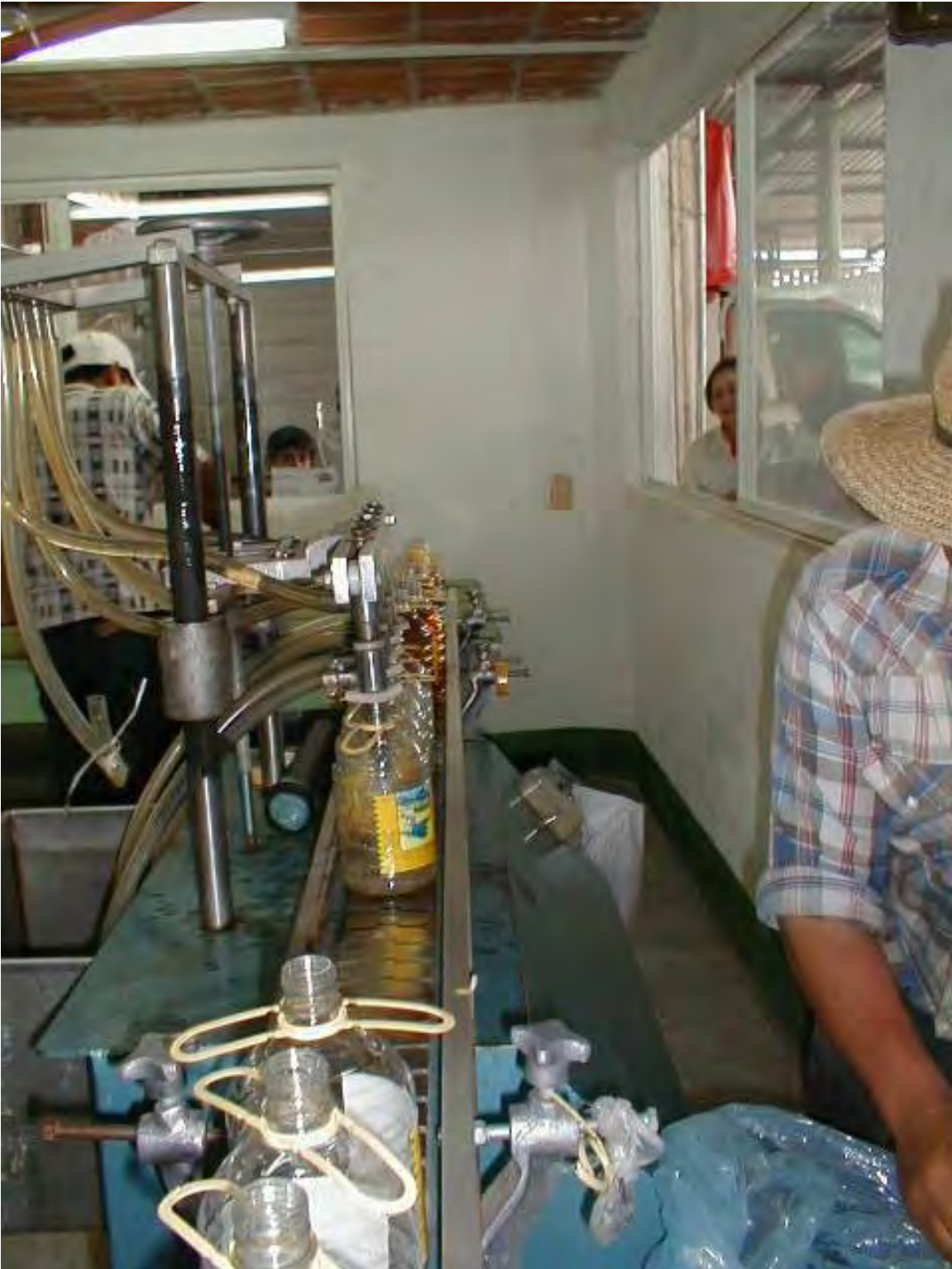
Fig. 127. Son las instalaciones industriales las tienen la posibilidad de envasar su propio producto. En este caso vemos el aparato que llena las botellas del “mezcalito” que se produce en Zacatecas.
