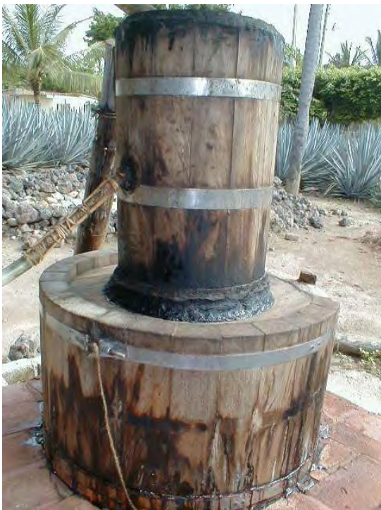
Fig. 45. Alambique de madera (montera y el contenedor del maguey fermentado) lo registramos en la comunidad de Mezcales en el estado de Nayarit.
