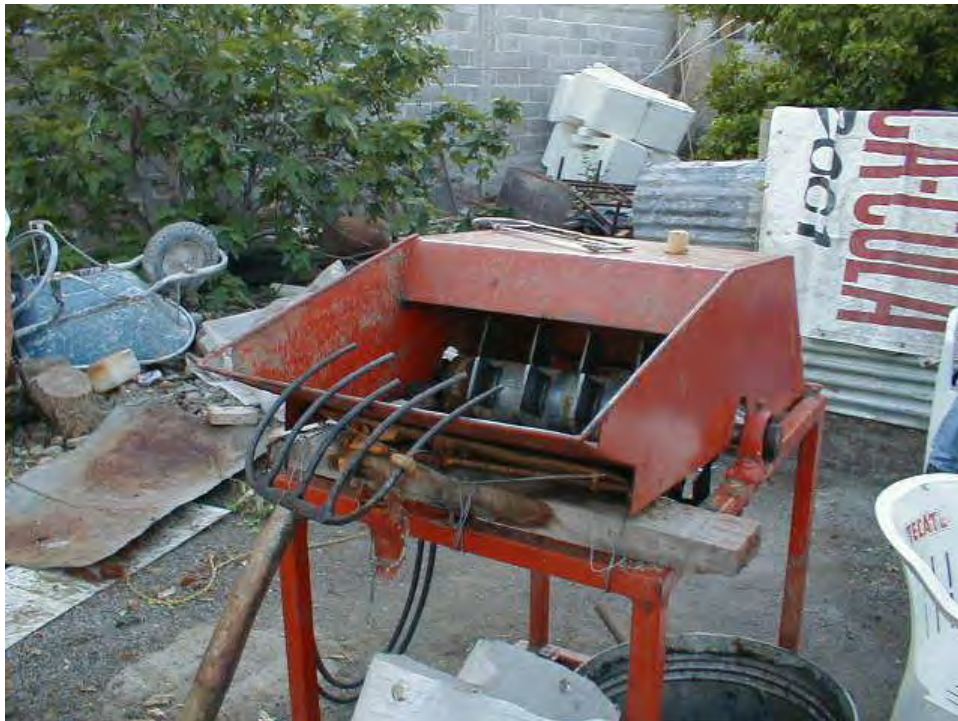
Fig. 93. Trituradora eléctrica que se utiliza en las instalaciones que producen la bebida llamada bacanora en el estado de Sonora.
