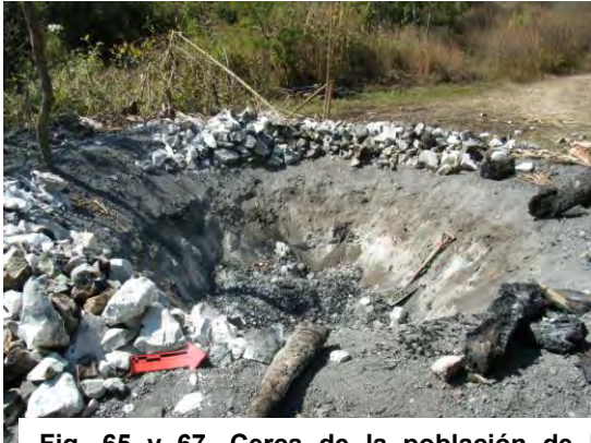
Fig. 65 y 67. Cerca de la población de Malinalco en el estado de México, comunidad de Zumpahuacán, encontramos destiladores con monteras de madera para los alambiques y hornos de pequeñas dimensiones con paredes de tierra.
