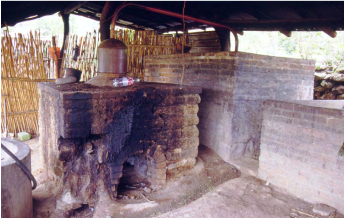
Fig. 114. Destilador común de cobre localizado en la comunidad de Hierve el Agua en el estado de Oaxaca.
