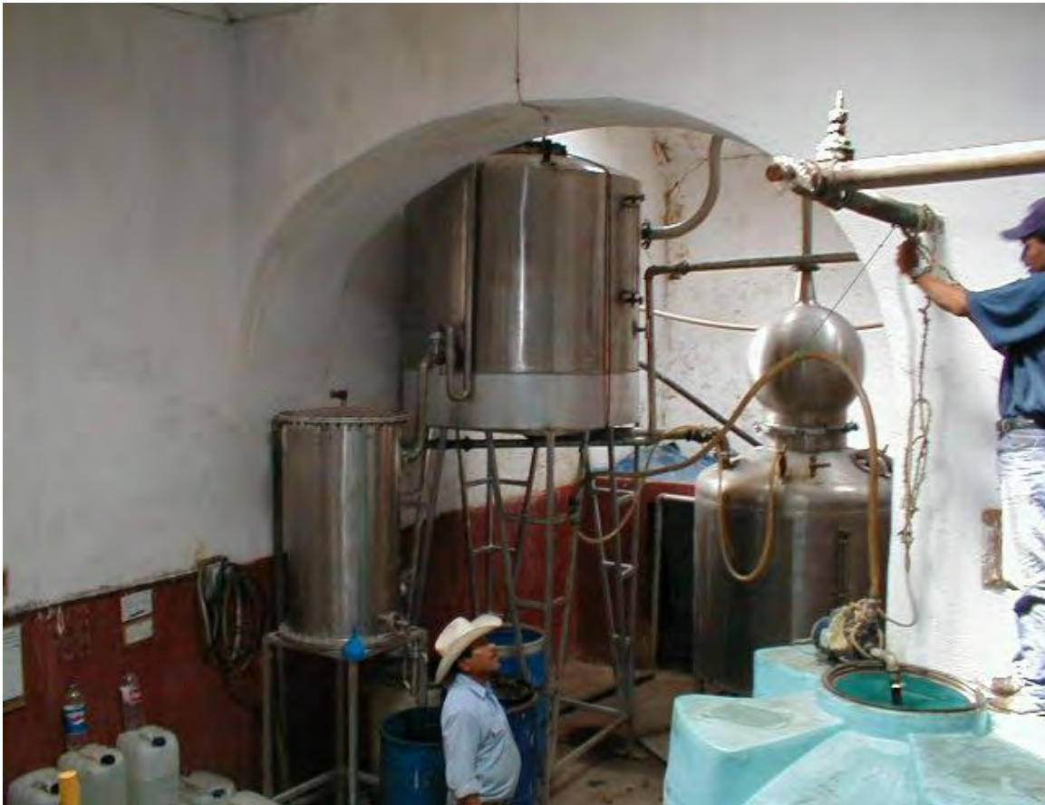
Fig. 116. Las instalaciones con más recursos pueden obtener alambiques con diferentes rectificadores y sistemas de control, hechos con acero inoxidable que pueden llegar a durar mas de 50 años, como el que aquí vemos de la fábrica de Ipiña, San Luis Potosí,.
