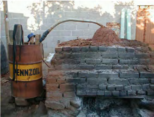
Fig. 35. En la población de Bacanora en el estado de Sonora, registramos fabricas de mezcal (localmente llamado bacanora) que combinan alambiques con serpentines (enfriadores) de metal colocados en tambos.
