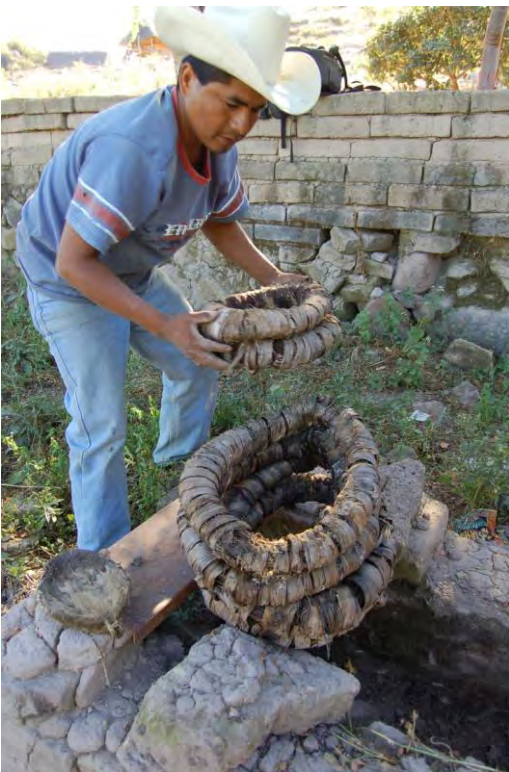
Figs. 59, 60, 61 y 62. Durante nuestra segunda visita a la comunidad huichola de Guadalupe Ocotán en Nayarit, se logró registrar una nueva variante de la elaboración del alambique. En la primera foto se observa como se utiliza zacatillo seco para el relleno de los aros, en la segunda y tercera foto como estos aros se superponen y finalmente en la cuarta foto, como en su interior, se coloca la pequeña bandeja que recibe la condensación de los jugos del maguey. Sin lugar a dudas este sistema indígena es el más rústico que encontramos en todo el país.
