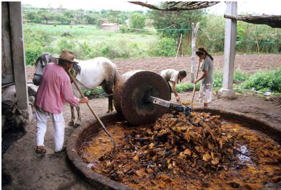
Fig. 95. Tahona impulsada con caballo en la comunidad zapoteca de Chichicapan, Oaxaca.
