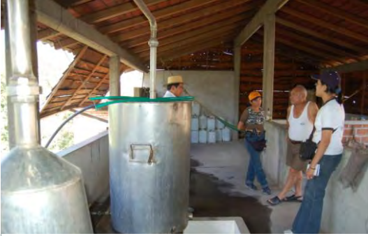
Fig. 54. Instalaciones con enfriadores y alambiques de acero inoxidable registramos en el Municipio de Comala del estado de Colima.
