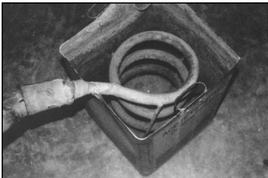
Fig. 118. En la comunidad de Xoyatla del estado de Puebla, encontramos un alambique con montera hecha con un tronco de árbol y un serpentín de pequeñas dimensiones colocado en un tambo metálico que sirve como pila de condensación.
