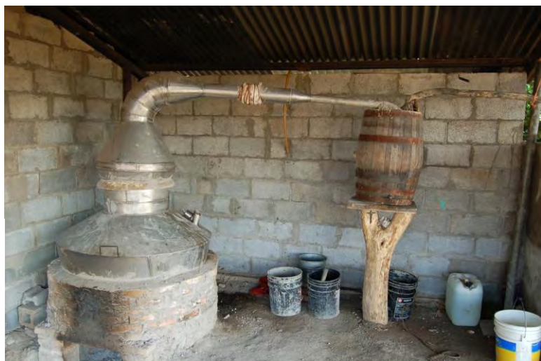
Fig. 57. Enfriador de metal en recipiente de madera combinado con alambique de acero inoxidable son materiales que utilizan en una de las fábricas del municipio de San Carlos, Tamaulipas.
