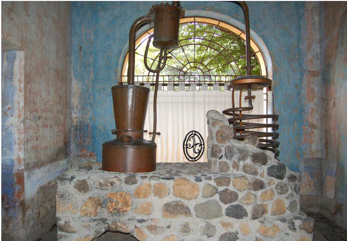
Fig. 15. Alambique de cobre con rectificador y serpentín. Instalaciones antiguas de la tequilera José Cuervo, Tequila, Jalisco, México.
