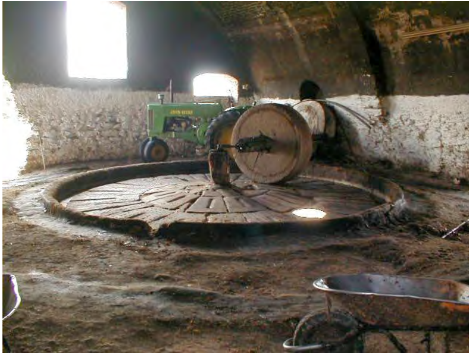
Fig. 94. Tahona impulsada con un tractor diesel en Laguna Seca, San Luis Potosí.
