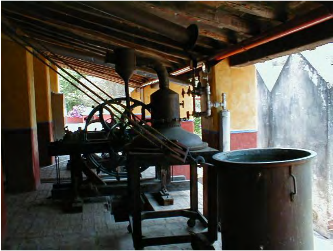
Fig. 112. Alambique con refinador. Fábrica de mezcal La Noria, Sinaloa.
