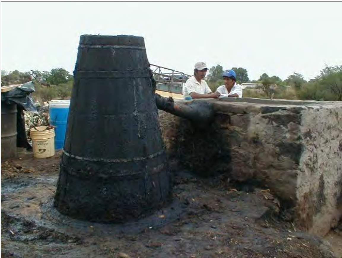
Fig. 110. En el estado de Durango encontramos uno de los mejores ejemplos de alambique constituido con cazo de cobre y un capitel o montera de madera al que le llaman “viejo”. Vinata La Constancia.
