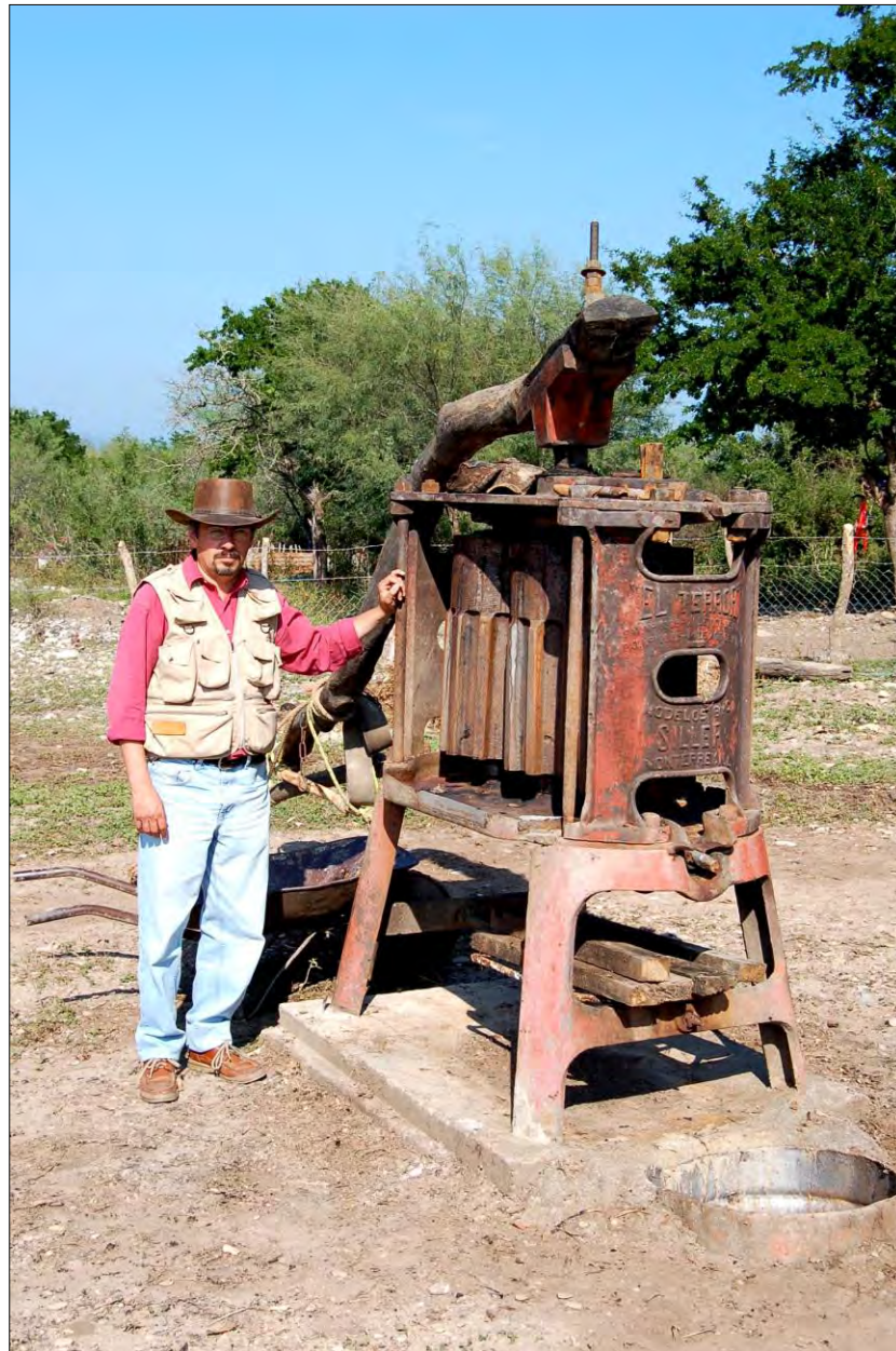
Fig. 98. Molino de engranes metálicos en el municipio de San Carlos, Tamaulipas. Es un instrumento que se trajo de Nuevo León y en su origen fue para machacar el mosto de la cebada para la cerveza.
