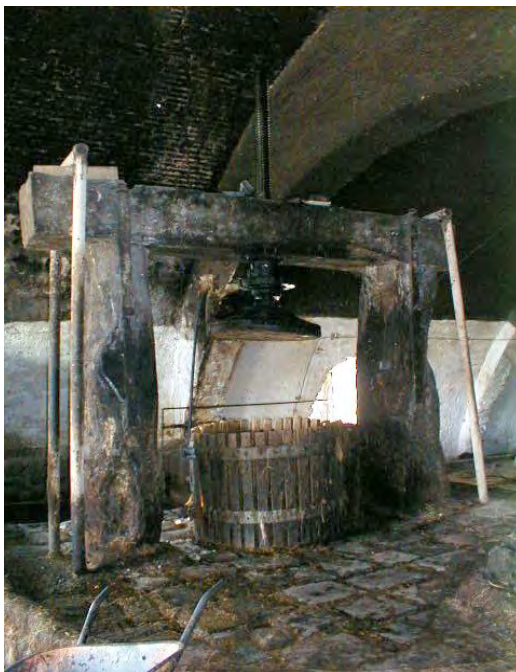
Fig. 96. Prensa vertical utilizada en la Fábrica de Laguna Seca, San Luis Potosí.
