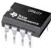
Figura 5.4: Amplificador Operacional de precisión.
