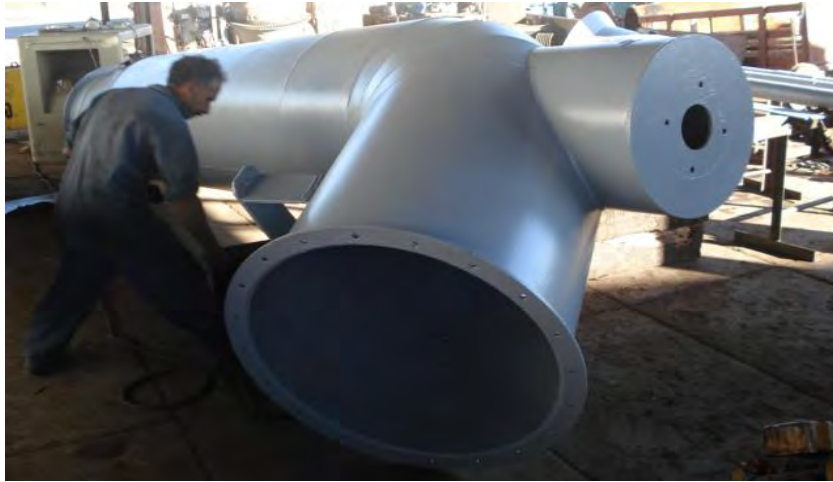
Figura 29 Cuerpo de la bomba acuícola después de mantenimiento
