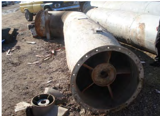
Figura 28 Cuerpo de la bomba acuícola antes de mantenimiento
