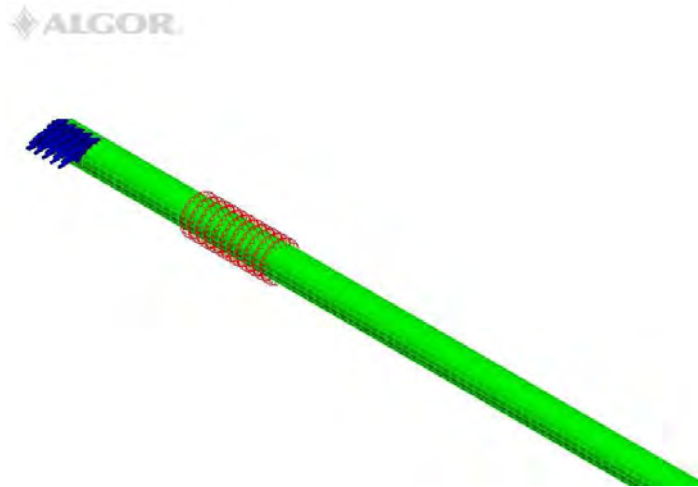
Figura 48 Condiciones de frontera en la flecha
