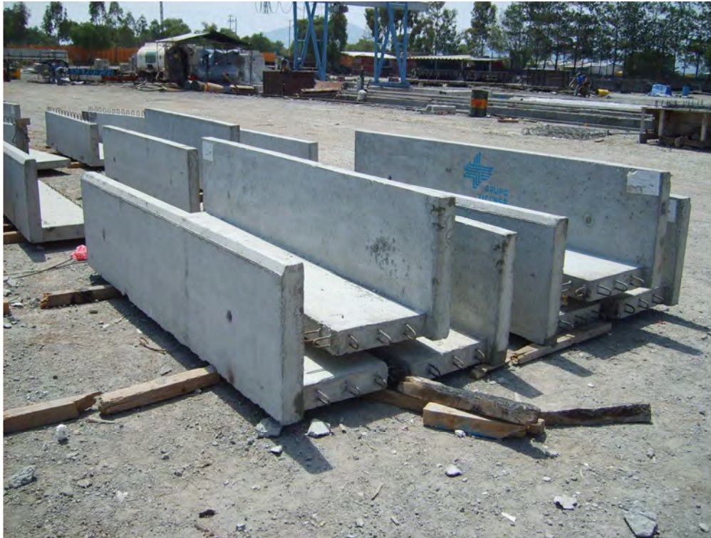
Figura III.17 Patios de fabricación, prefabricados tipo “L”.
