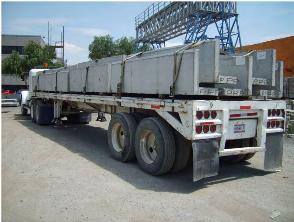
Figura III.19 Carga de prefabricados para su traslado a sitio de obra.
