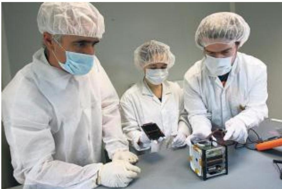
**Figura 1. 1 Ensamblado del XATCobeo en cámara limpia.**
