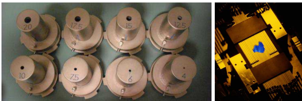
Figura 2-1. Izquierda: Colimadores circulares (accesorios) usados en tratamientos de radioneurocirugía en el INNN. El número indica el diámetro del campo en milímetros proyectado en el isocentro. Derecha: m_3 -mMLC (imagen tomada de (BrainLAB, 2011)).
