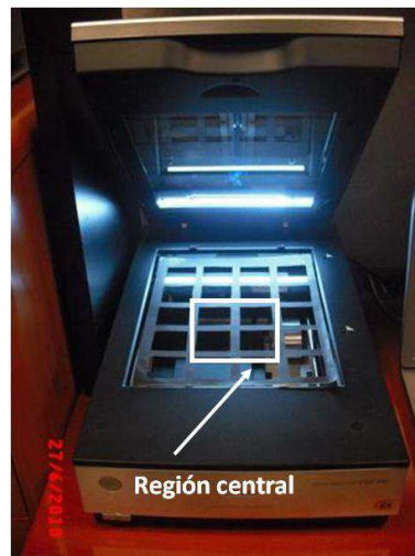
Figura 4-1. Máscara para dividir la cama del escáner y evaluar la uniformidad espacial de la respuesta.
