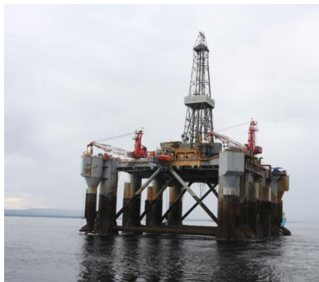
Fig. II.14 Semisumergible DSS38 (estabilizada por columnas)
