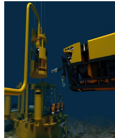
Fig. II.37 Conexión de configuración vertical asistida por un ROV
