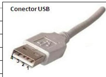
Figura 6.4 Terminales del conector USB
