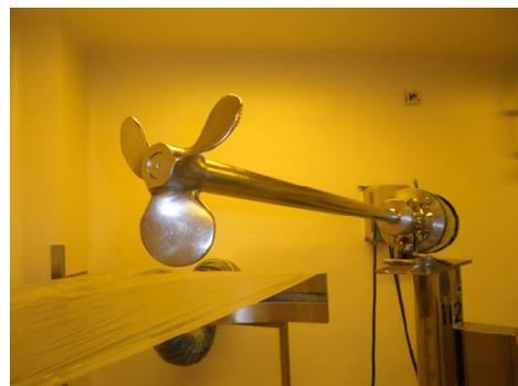
Figura 1.6 Agitador con propela de acero inoxidable
