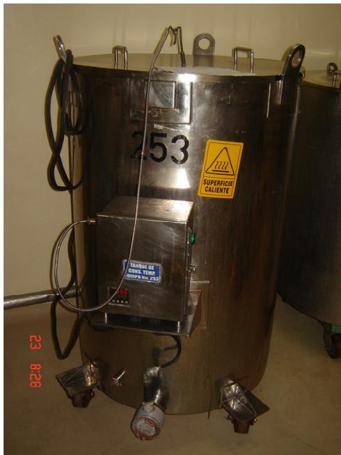
Figura 1.7 Tanque en proceso de maduración de gelatina
