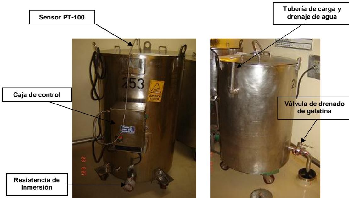
Figura 2.2 Frente del tanque
