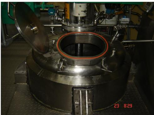
Figura 1.3 Homogeneizador con escotilla abierta
