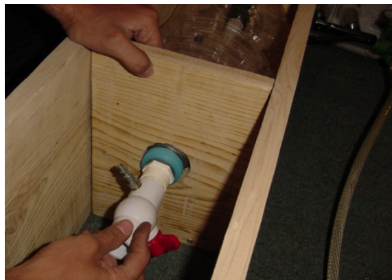
Figura 3.3. Retorno de biogás para agitación.
