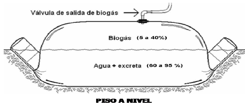
Figura A1.3. Digestor tubular de polietileno.
