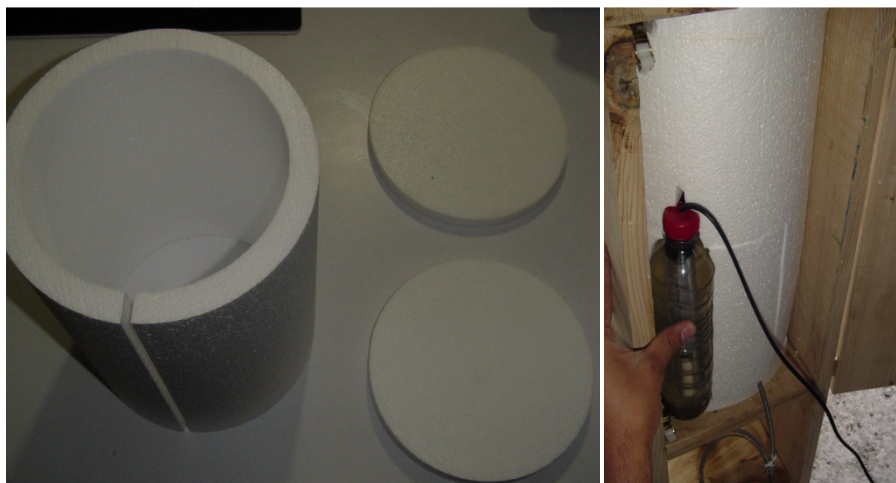
Figura 3.4. Izquierda: Aislamiento térmico, derecha: calentador con termostato.
