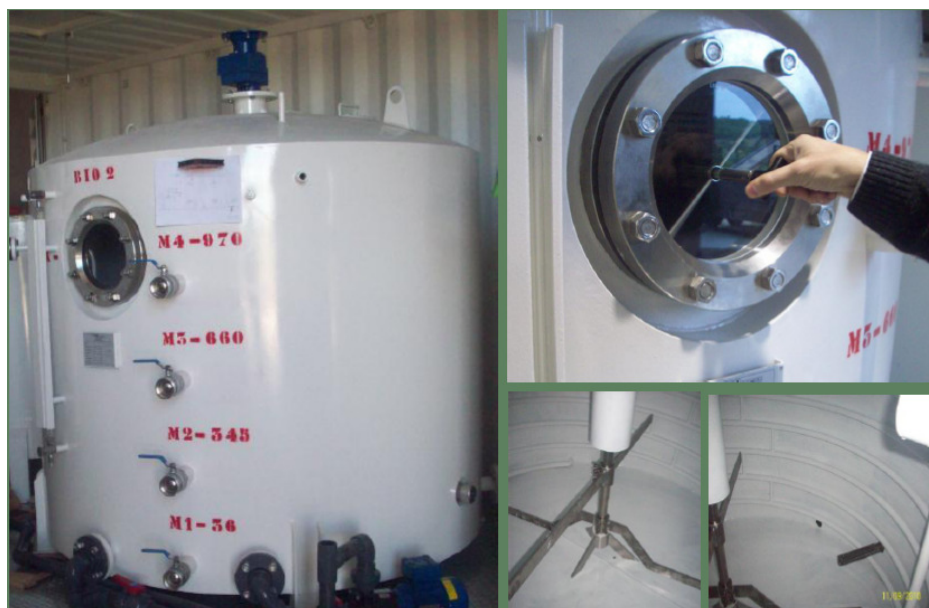
Figura 2.1. Planta piloto para biogás Aqua Limpia.
