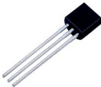
Figura 5.3. Sensor de temperatura LM35.
