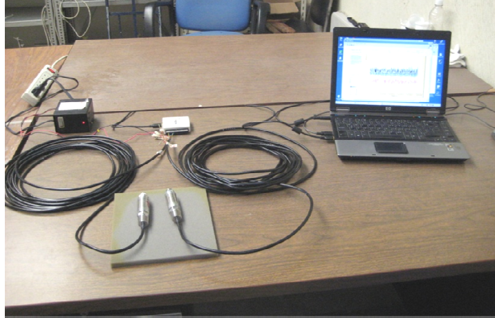
Figura C- 1. Registro del ruido en transductores expuestos al aire
