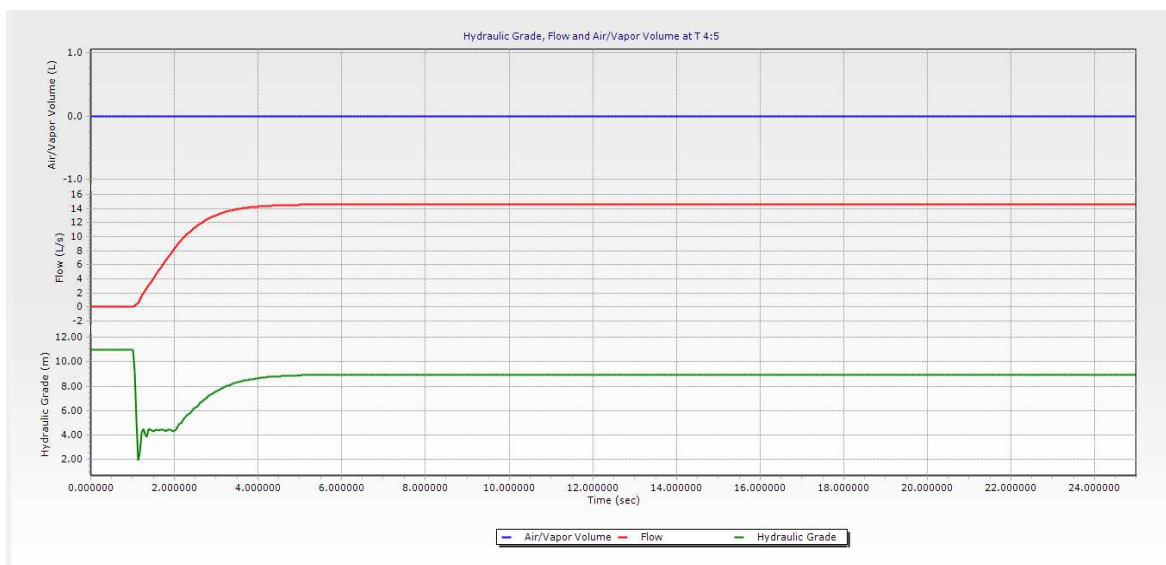
Figura D- 2. Perfil de una prueba con una apertura de un segundo en la sección aguas arriba (Nodo 5 del esquema anterior)
