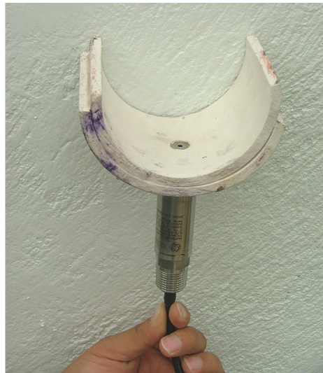
Figura 4-1. Pieza especial para el sensor no sobresalga de la tubería en el banco de prueba
