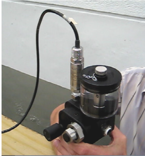
Figura C- 5. Purga transductor No. 1 con la Bomba manual
