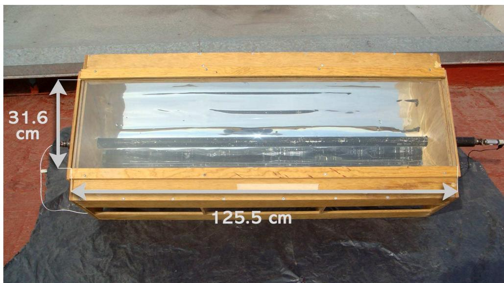
Figura 1.12: Colector solar prototipo; con este se realizaron todas las mediciones para la realización de esta tesis.
