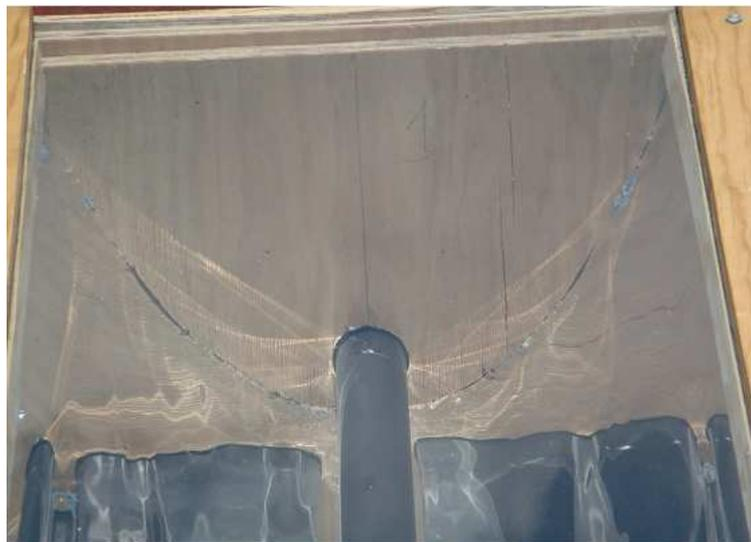
Figura 1.28: Trazado de rayos en el colector solar prototipo.
