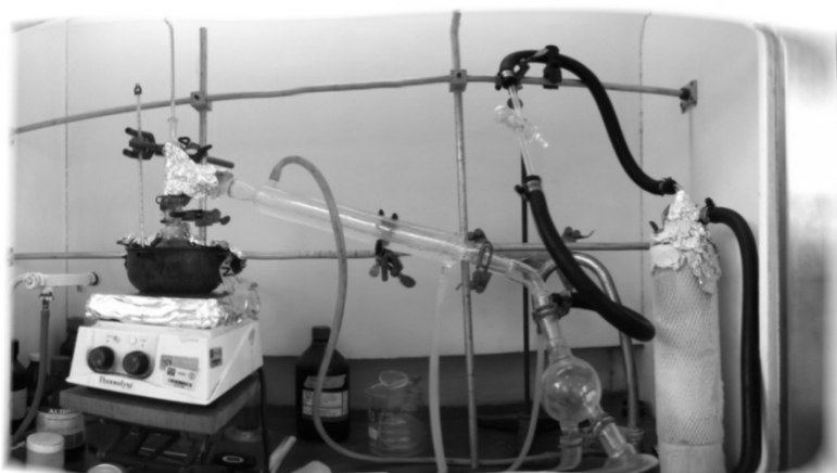
Figura 17. Destilación a presión reducida
