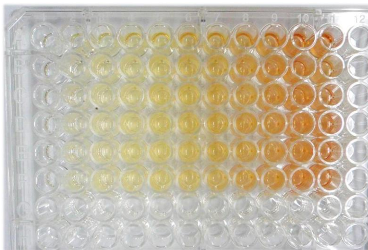
Figura 10. Estudio de la cinética de inhibición de \alpha -glucosidasa a diferentes concentraciones de p -NPG y de \omega -hidroxiemodina ( 108 ).
