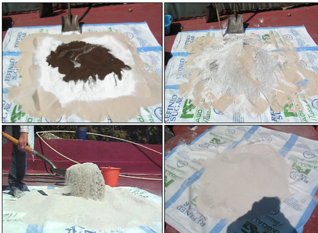
Figura 12. Conformación del suelo artificial
