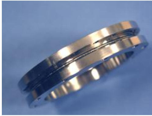
Fig. 2.10 –Soldadura de acero inoxidable con un láser de CO 2 de la marca Synrad
