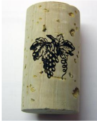
Fig. 2.12 –Marcaje de corcho con un láser Synrad de CO2 de 10W
