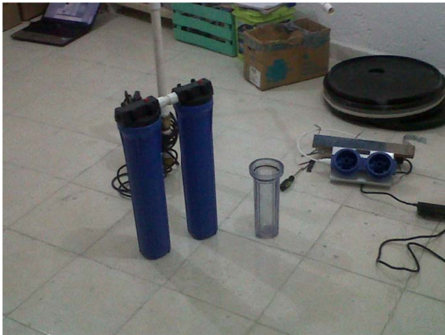
Figura 30. Filtros utilizados para purificación de agua de lluvia
