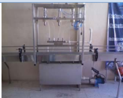
9.- LAVADORA Y LLENADORA DE GARRAFONES
