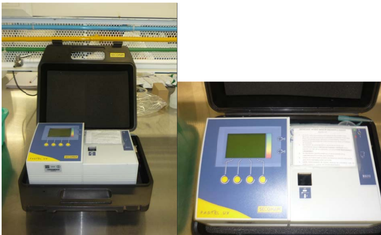
Figura 25. Equipo Pastel-UV, para análisis de parámetros de agua de lluvia.
