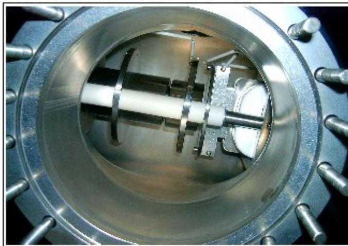
Figura 2.12. Fotografía de las lentes Einzel al interior del cañón de iones
