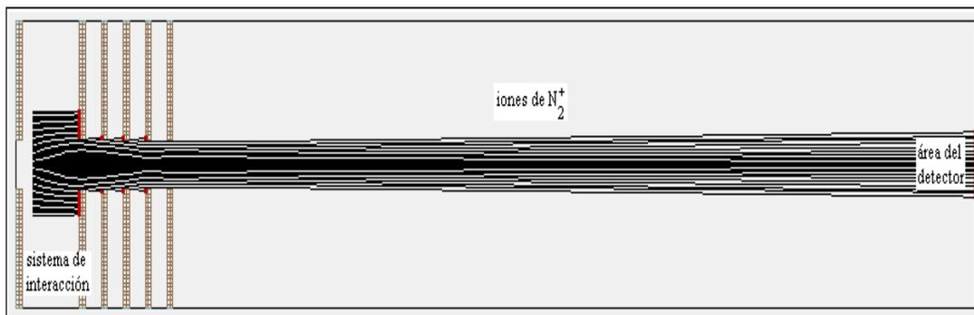
Figura 4.4. Imagen de la simulación de los iones  $N_2^+$  en el tubo de tiempo de vuelo, donde el voltaje en el disco 1 es de  $V_1 = 700$  V y en el disco 5 es de  $V_5 = 200$  V.
