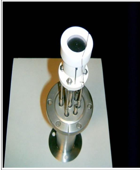
Figura 2.10. Fuente de iones Colutron.
