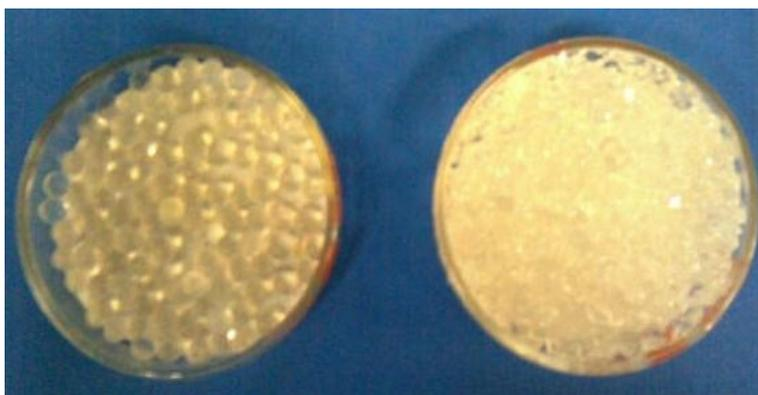
**Figura 19:** La figura de lado izquierdo de la Fotografía corresponde a las esferas que fueron sometidas a solución de pH 1, las esferas que se mantuvieron íntegras se sometieron a la solución de pH 8 donde se puede observar en la figura de lado derecho, al término de 1 hora las esferas se fragmentaron por completo.
