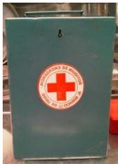
Botiquín mediano 40 x 30 x 10 cms, fabricado en lamina de acero calibre 24, con orificios en la parte posterior para colgar en pared, cuentan con entrepaños y divisiones en su interior, así como chapa sencilla.
