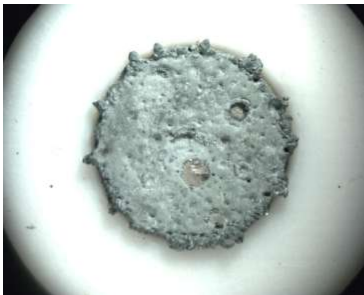
Figura 49. Depósito con 0 rpm durante 3 hrs. Estereoscopio a 1.5x.
