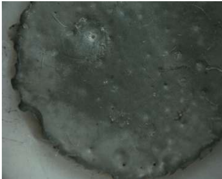
Figura 53. Depósito con 100 rpm durante 3 hrs. Estereoscopio a 4x.
