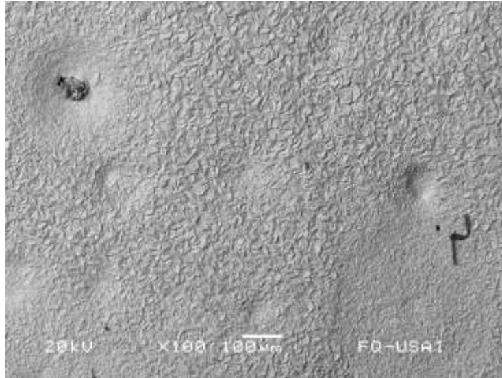
Figura 66. Depósito con 0 rpm y sin aditivo durante 3 hrs. MEB a 100x.
