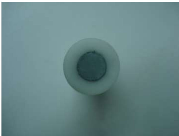
Figura 63. Depósito con 100 rpm y 50 ppm de cloruro de tetrametil amonio durante 3 hrs. Cámara Digital.
