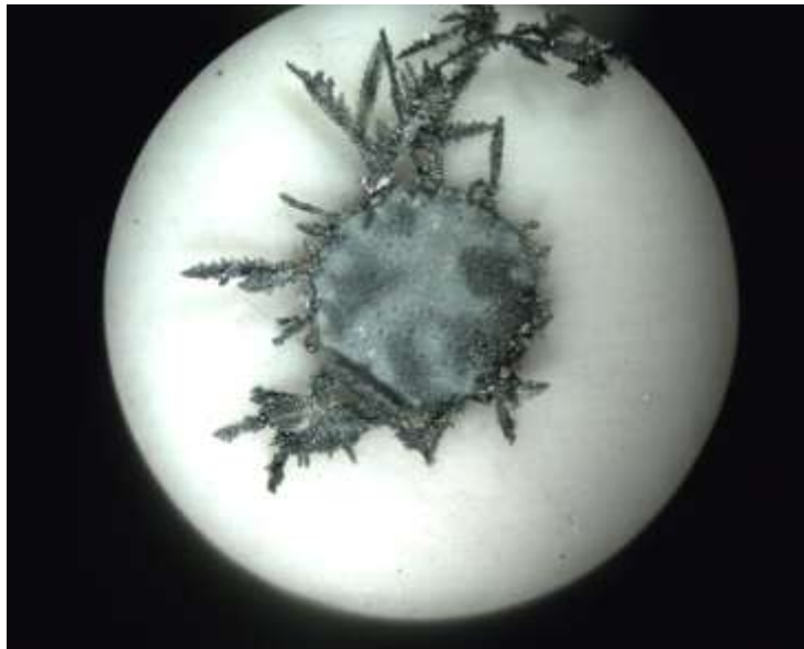
Figura 34. Depósito con 0 rpm y 50 ppm de cloruro de tetrametil amonio. Estereoscopio a 1.5x.
