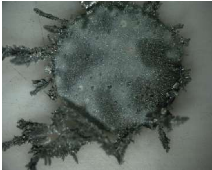
Figura 35. Depósito con 0 rpm y 50 ppm de cloruro de tetrametil amonio. Estereoscopio a 4x.
