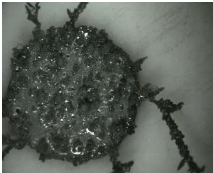
Figura 26. Depósito con 750 rpm. Estereoscopio a 4x.
