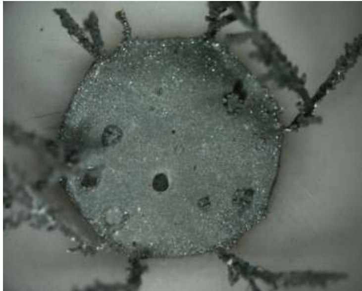
Figura 38. Depósito con 100 rpm y 50 ppm de cloruro de tetrametil amonio. Estereoscopio a 4x.
