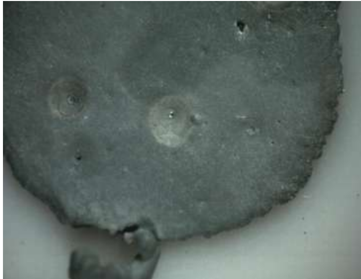
Figura 56. Depósito con 0 rpm y 50 ppm de alcohol decílico durante 3 hrs. Estereoscopio a 4x.
