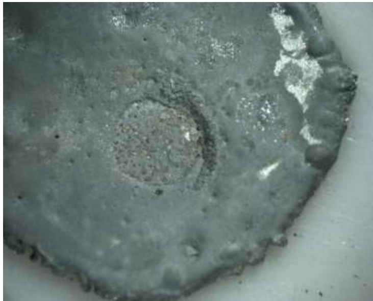
Figura 59. Depósito con 100 rpm y 50 ppm de alcohol decílico durante 3 hrs. Estereoscopio a 4x.
