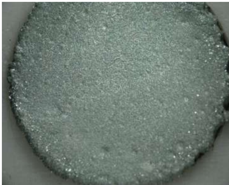
Figura 65. Depósito con 100 rpm y 50 ppm de cloruro de tetrametil amonio durante 3 hrs. Estereoscopio a 4x.
