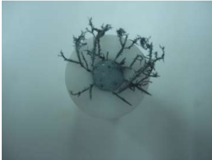
Figura 36. Depósito con 100 rpm y 50 ppm de cloruro de tetrametil amonio. Cámara Digital.
