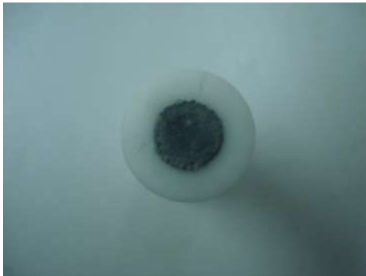
Figura 51. Depósito con 100 rpm durante 3 hrs. Cámara Digital.
