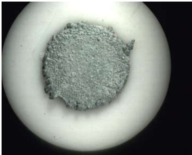
Figura 61. Depósito con 0 rpm y 50 ppm de cloruro de tetrametil amonio durante 3 hrs. Estereoscopio a 1.5x.
