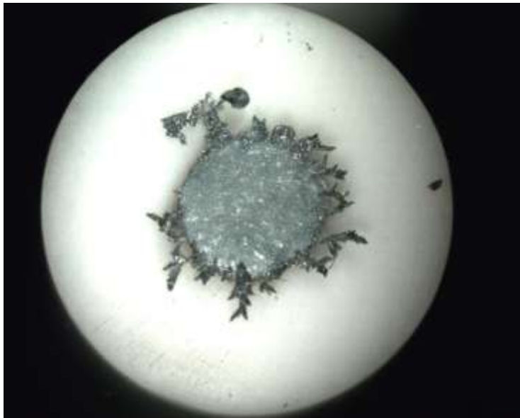
Figura 22. Depósito con 100 rpm. Estereoscopio a 1.5x.
