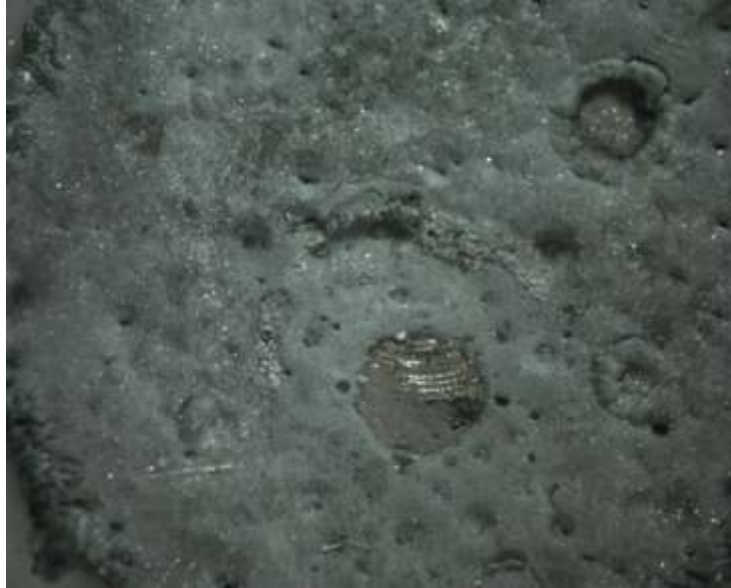
Figura 50. Depósito con 0 rpm durante 3 hrs. Estereoscopio a 4x.
