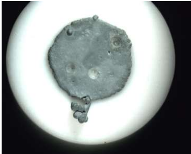
Figura 55. Depósito con 0 rpm y 50 ppm de alcohol decílico durante 3 hrs. Estereoscopio a 1.5x.
