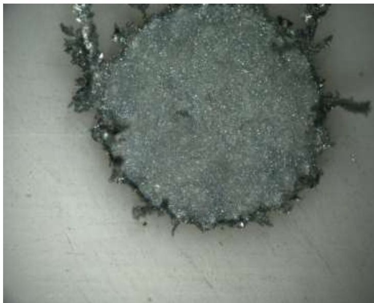
Figura 32. Depósito con 100 rpm y 50 ppm de alcohol decílico. Estereoscopio a 4x.
