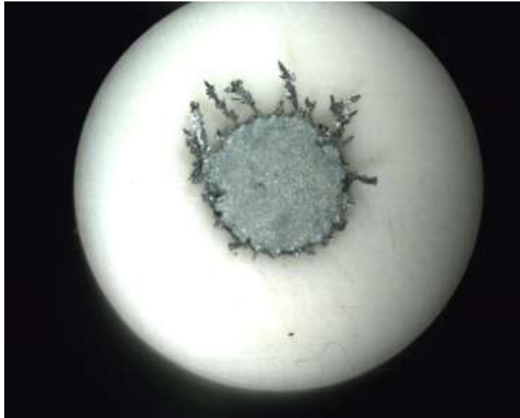
Figura 31. Depósito con 100 rpm y 50 ppm de alcohol decílico. Estereoscopio a 1.5x.
