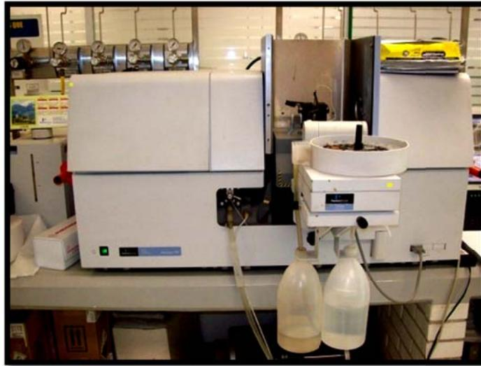
Figura4.12. *Espectrofotómetro (Perkin-Elmer Analyst 700) Con aditamento de horno de grafito.*
