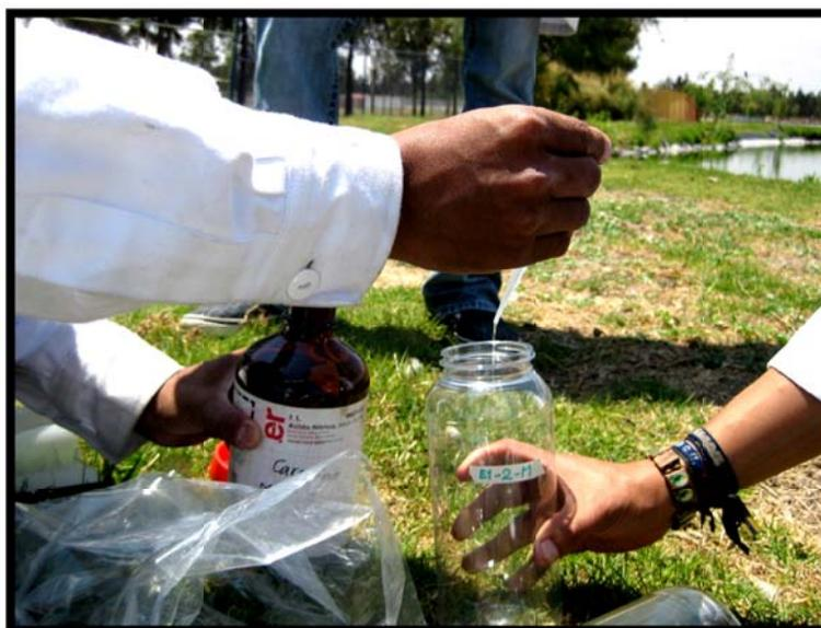
Figura 4.8. Adición del ácido nítrico.
