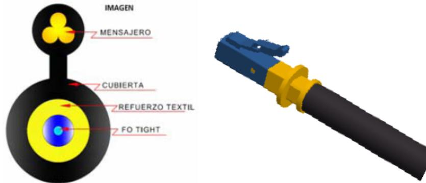
Fig. 3.8 Cordón de acometida óptica preconectorizado.
