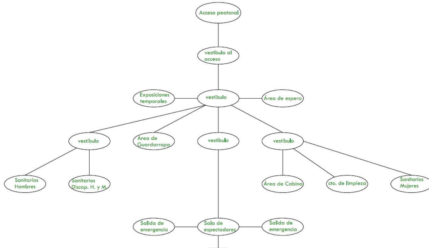
Figura 4.2.1.1 Esquema de funcionamiento particular del Auditorio (área pública).
