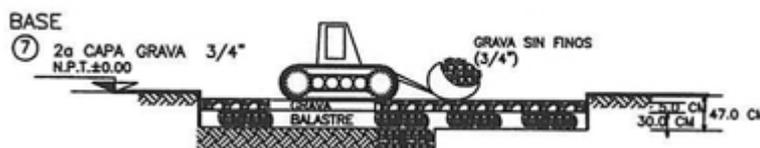
8. Una vez colocada la base de grava de  $\frac{3}{4}$ " y perfectamente nivelada y afinada, se rodará un rodillo liso, primero en "estático" y posteriormente "con vibro" para permitir el acomodo adecuado de los materiales pétreos. El grado de acomodo se dará en el momento en que el rodillo no deje huella de su orilla o canto sobre la superficie rodante.
