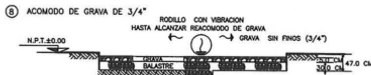
9. Una vez acomodada la base de grava de  $\frac{3}{4}$ " y perfectamente nivelada y afinada se procederá a realizar los trabajos de colocación del Concreto Ecológico hecho en espesor de 12 cm., con un  $f'c=250 \text{ Kg. /cm}^2$ .
