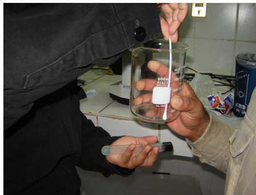
Figura 1. Toma de muestra de un vaso de precipitado con ayuda de un hisopo estéril.
