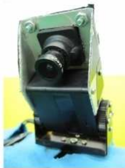
Figura 2.5: Visión monocular montado sobre un sistema de servomotores con dos grados de libertad.
